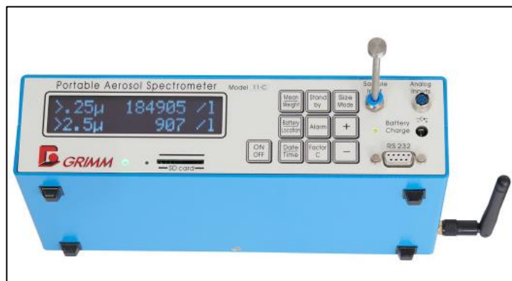
Figura 7. Mini Laser Aerosol Spectrometer Model 11-C (GmbH & Co.KG, 2016a).
