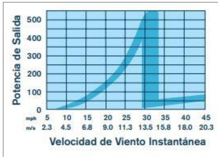
Figura 13: Curva de potencia de Aerogenerador [31].
