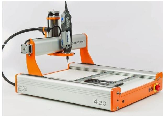
Figura 2.3: Máquina CNC estándar, utilizando un Dremel
