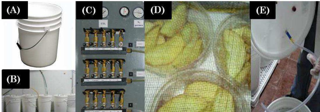
**Figura 1.** Materiales utilizados para atmósfera controlada. A: contenedores de polietileno (20 L). B: sistema de flujo continuo de contenedores de polietileno. C: panel mezclador de gases. D: recipientes de polietileno de 500 mL, con malla de acero inoxidable. E: tapas de contenedores con mangueras interconectadas.
