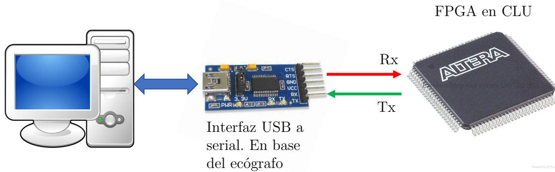
Figura 5.6: Esquema de comunicación. La FPGA de la CLU está conectada a la interfaz Serial-USB ubicada en la base de Taote .
