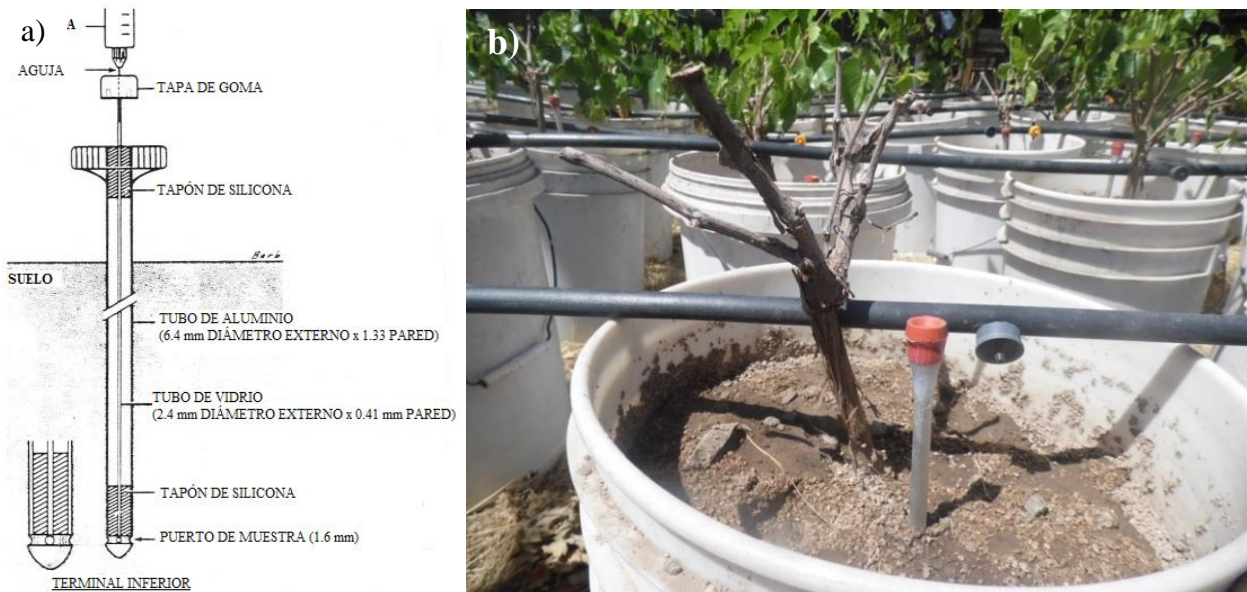
Figura 1. (a) Esquema de la herramienta utilizada para muestrear la atmósfera del suelo (modificada de Staley (1980)). (b) Tubo de aluminio para extracción de etileno.
