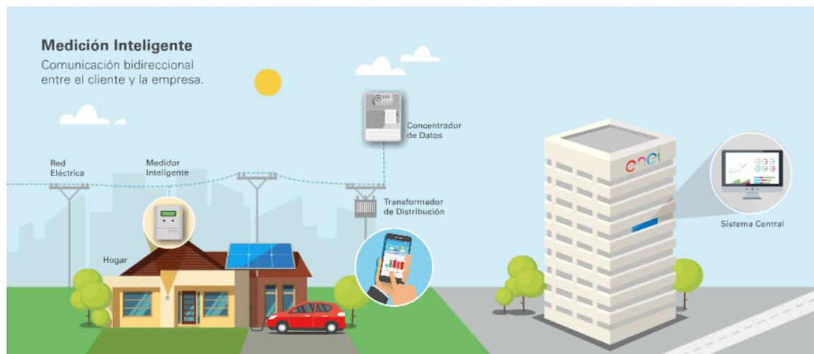
Figura 6.3. Esquema de solución para Medición Inteligente en Enel (Enel Distribución, s.f.).
