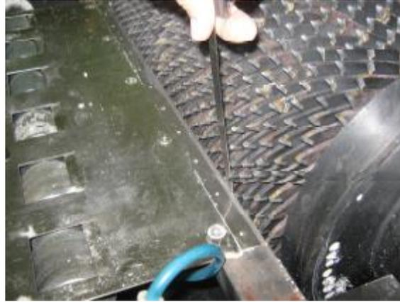
Ilustración 5. Molino de celulosa. En la imagen se representa el rotor y sus martillos.
