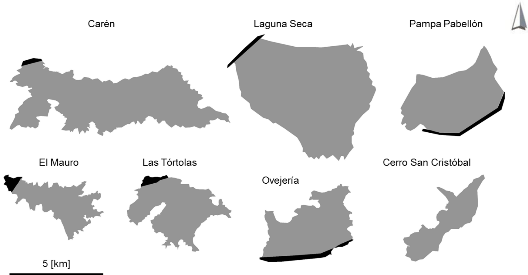
Figura 2.6. Vista en Planta de los principales depósitos de relaves en Chile, comparados con el Cerro San Cristóbal (Chile)
