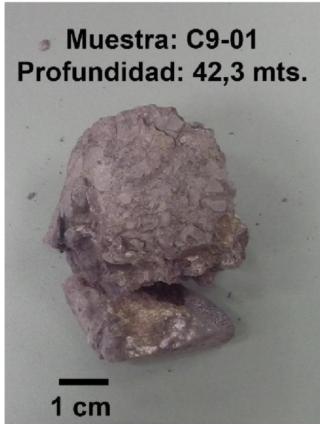
Ilustración 4.3 Muestra C9-01. Dacita. Corte transparente en la Tabla 4.3.
