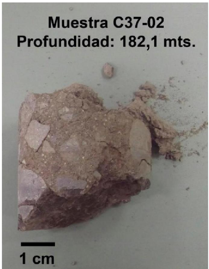
Ilustración 4.1 Muestra unidad Gravas Inferiores del sondaje S-1, extraída a una profundidad de 182,1 metros
