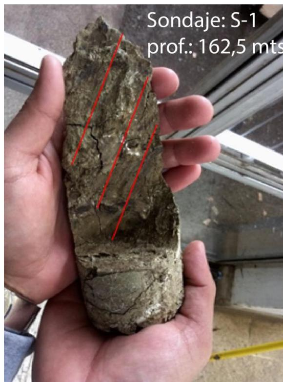
Ilustración 4.13 Plano de falla encontrado en la subunidad H, con líneas rojas se sigue la dirección de las estrías de falla ( $70^\circ$ ).
