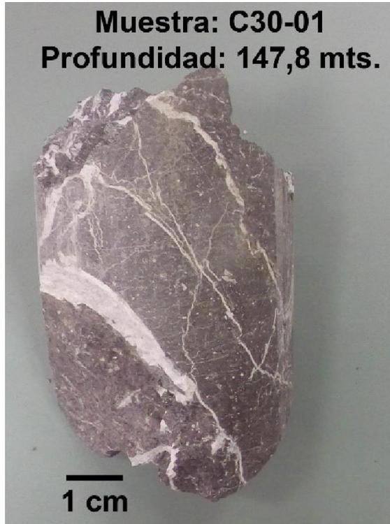
Ilustración 4.6 Muestra C30-01. Andesita. Corte transparente en la Tabla 4.9.
