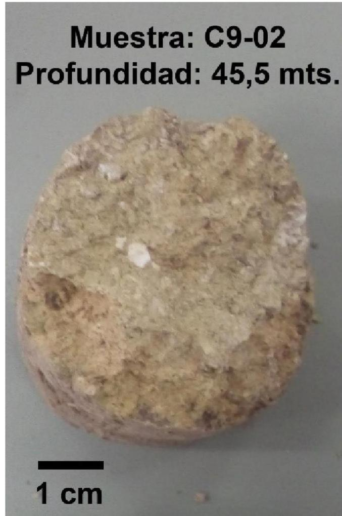
Ilustración 4.4 Muestra C9-02. Andesita. Corte transparente en Tabla 4.4.
