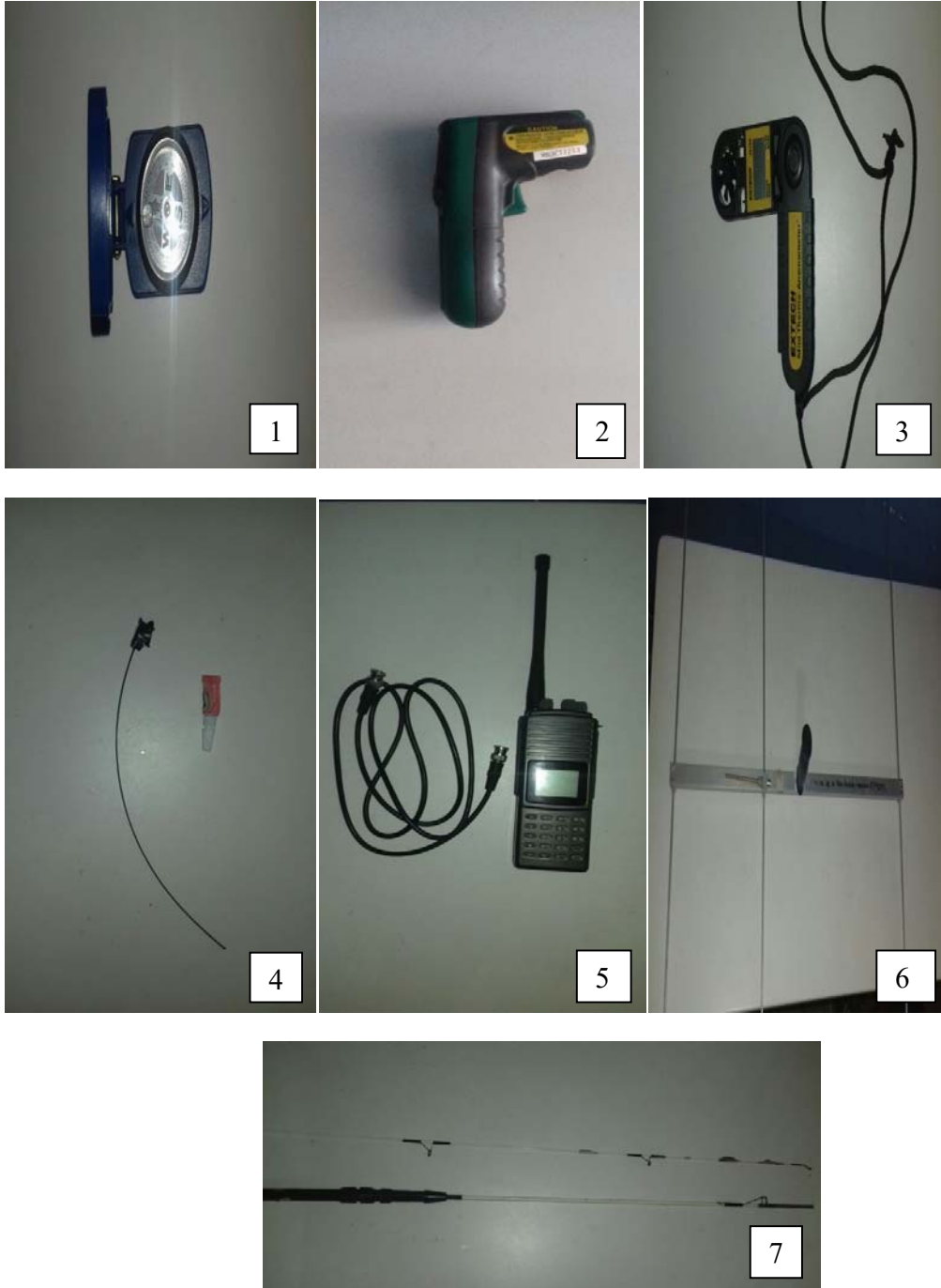
Brujula (1), Termometro infrarrojo (2), Termoanemometro (3), Transmisor y pegamento (4), Receptor (5), Antena Yagi (6), Caña con lazo (noosing) (7).
