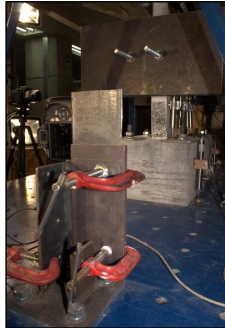
Figura 3.21. Configuración de focos y cámaras. a) focos frontales y cámaras 1,2,4 y 5; b) soporte de cámara lateral
