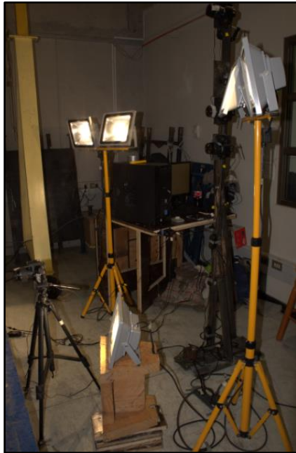
Figura 3.21. Configuración de focos y cámaras. a) focos frontales y cámaras 1,2,4 y 5; b) soporte de cámara lateral
