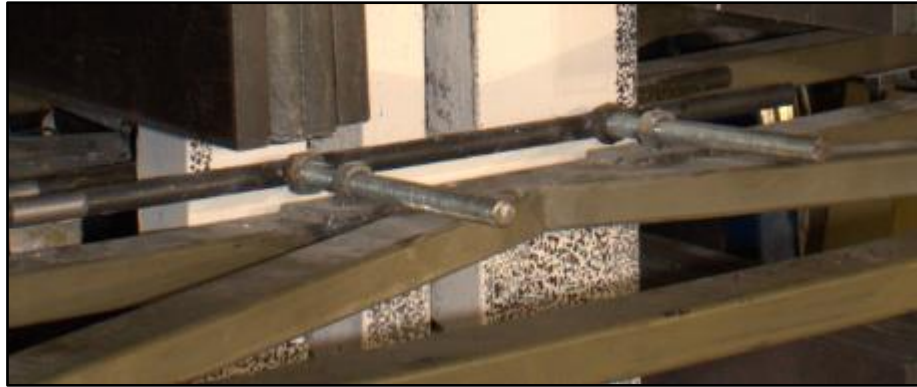
Figura 3.9. Restricción lateral instalada
