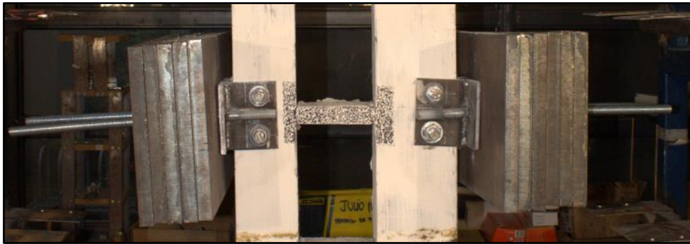
Figura 3.13. Detalle de soportes y pesos instalados
