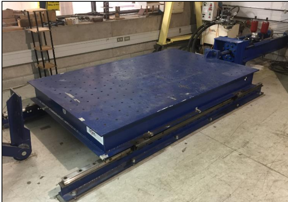
Figura 3.7. Mesa vibratoria unidireccional del laboratorio LEE
