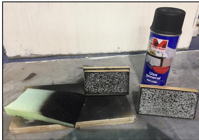
Figura 3.17. Implementos utilizados para estampar sobre la superficie de hormigón
