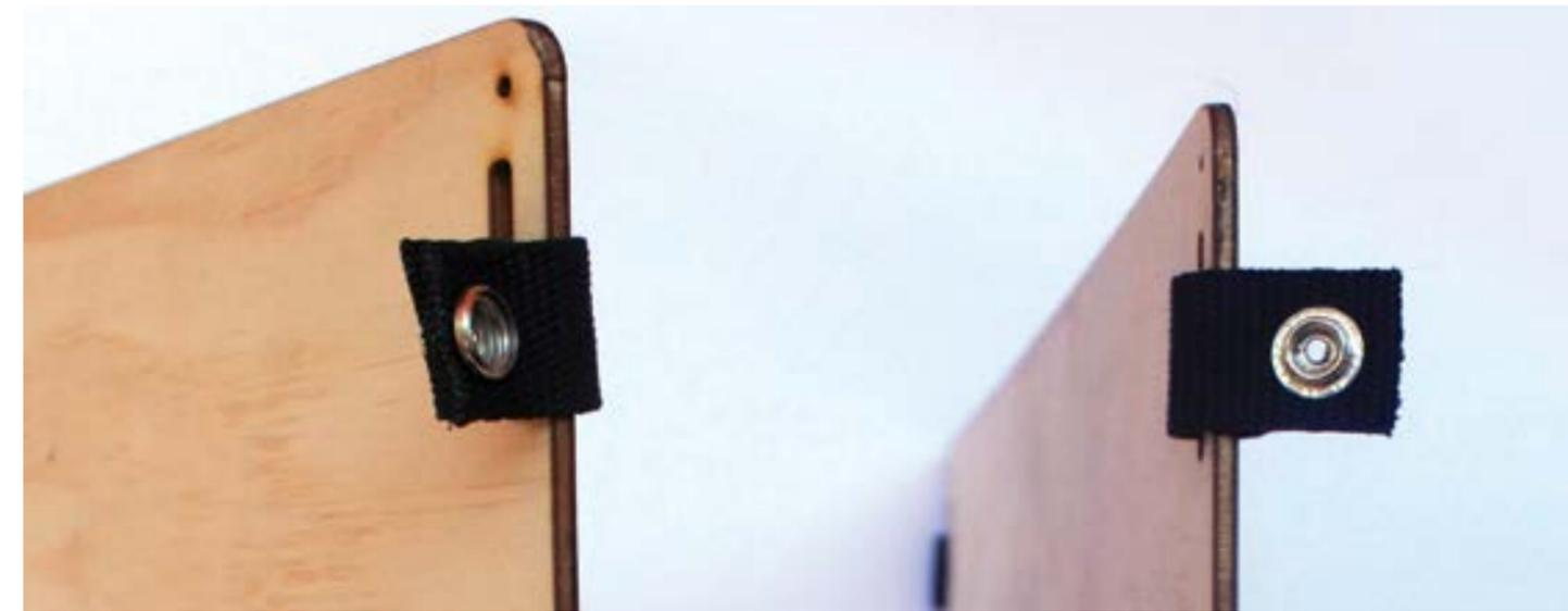
*Encaje con broches. Los broches encajan perfectamente, sin embargo, la estructura total no queda perfectamente alineada.*
