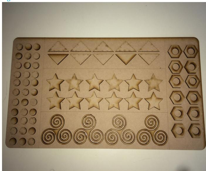
Figura 36: Las figuras geométricas luego de ser cortadas fueron pegadas con adhesivo de contacto. Se utilizó grabado laser en los contornos para un fácil pegado y ubicación de las piezas.
