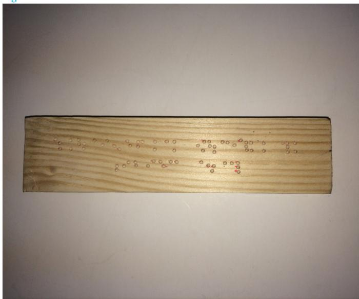
Figura 74: Para esto se utilizó una fresa de 1,5 mm para poder realizar los puntos de braille. Se utilizó cinta adhesiva para fijar la altura al bajar la fresa sobre la superficie a perforar.
