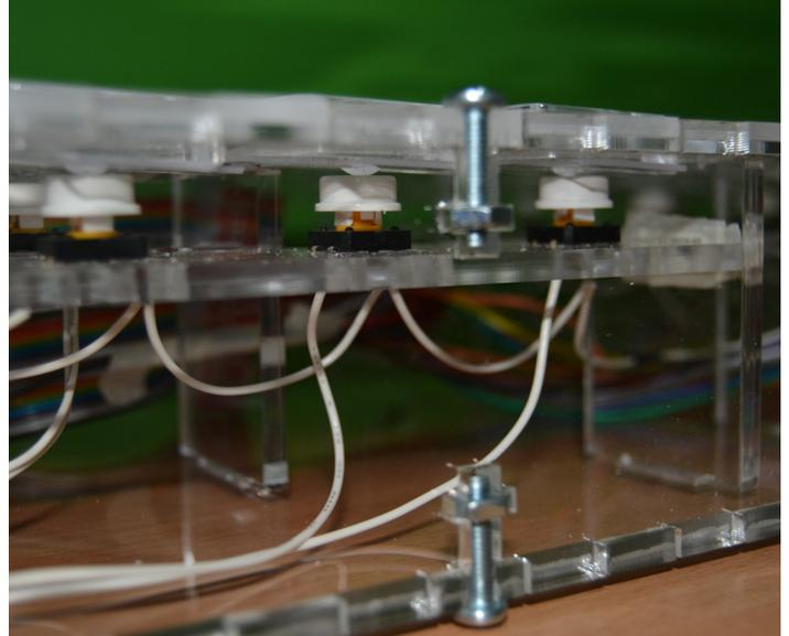
Figura 97: Se corrigió la posición del botón de apagado con respecto a la versión anterior. Se puede apreciar el sistema T-Slot en la construcción del prototipo.
