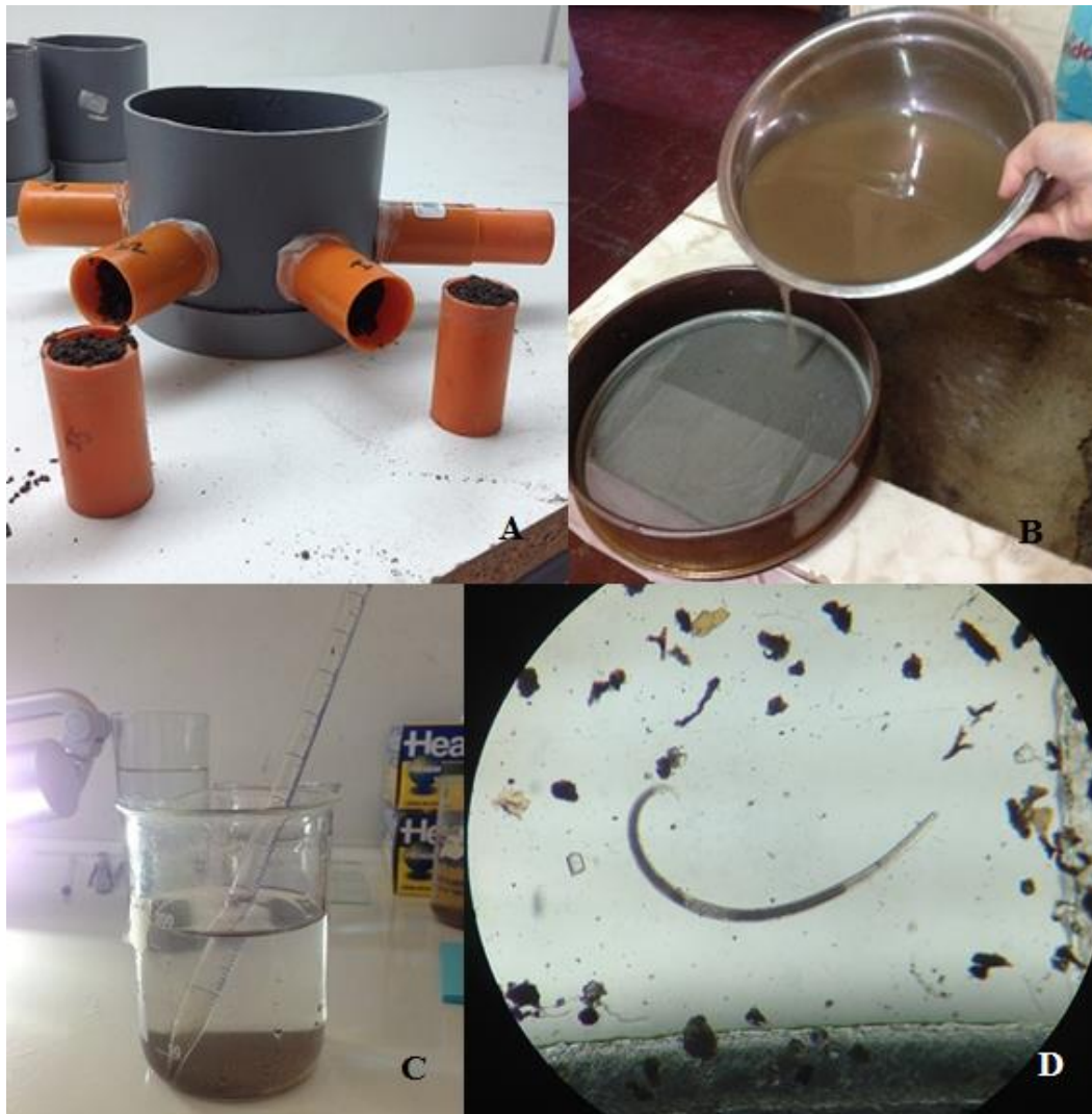
Figura 6. A) Del olfactómetro se desacoplan los tubos conectores/colectores para B) tamizar el volumen de suelo en su interior, cada tubo por separado. C) El suelo que queda en el tamiz final se trasvasija a un vaso precipitado y se rellena con agua hasta completar los 200 mL. El contenido del vaso se revuelve y se extraen 10 mL que son puestos en una placa para conteo de nematodos D) y se observa a la lupa a 50X.
