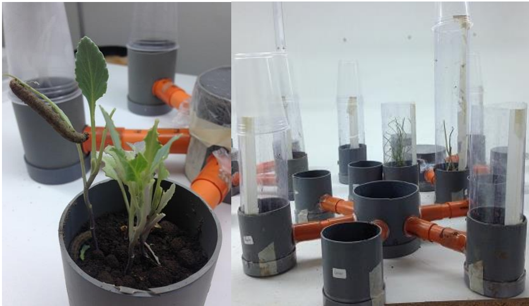
Figura 7. Maceta con plantas de repollo comidas por larvas de A. bilitura después de 2 días del montaje (izquierda). Olfactómetro con plantas dañadas casi en su totalidad por A. bilitura luego de 5 días del montaje (derecha).
