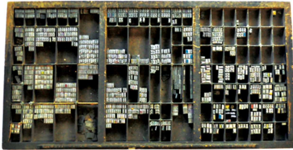
Arriba, una caja de tipos de metal cuerpo 30, sans serif, condesadas, perteneciente a Güiña.
