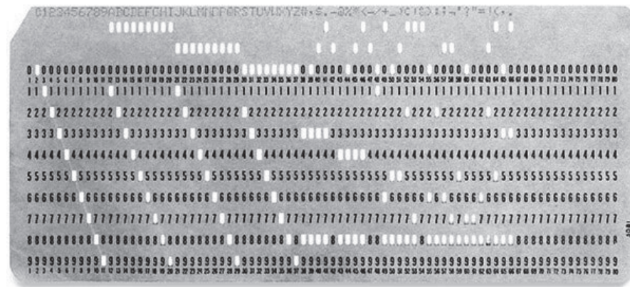
Fig (14) La tarjeta perforada IBM año 1993 , que resulta ser código binario. Estas tarjetas fueron utilizadas durante la década de los 60 y 70 para ingresar información e instrucciones en los computadores.
