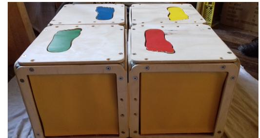
La primera actividad se conforma por 4 circuitos electrónicos compuestos por tira de leds, un botón pulsador conectado y otro desconectado, energizado con una batería de 9 volts, con un estuche adosado a la madera. Cada huella se compone de un circuito.
