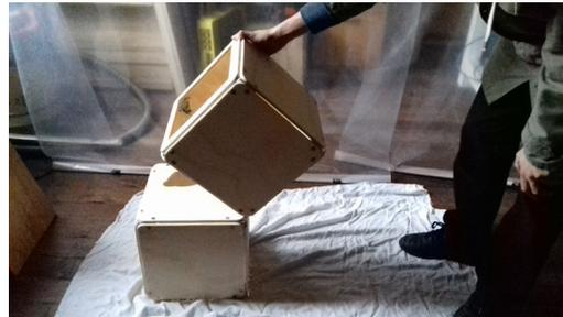
Para el armado de cada módulo se ubicaron las piezas en el suelo, se pusieron escuadras, bisagras y pernos. comenzando por la base del cubo y finalizando por la cara superior, una cara se dejó fuera para poner las partes internas y juntar aristas con bisagras de tela.
