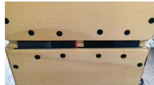
La unión de aristas se realiza con tela de lona engomada gruesa de alta resistencia a la tracción, listones de madera y pernos para su agarre, cruzando de un cubo a otro. El cubo se logra estructurar resistiendo peso de hasta 70 kilos sin problemas, pero la bisagra de tela se tuerce hacia los lados cuando se mueven los cubos.
