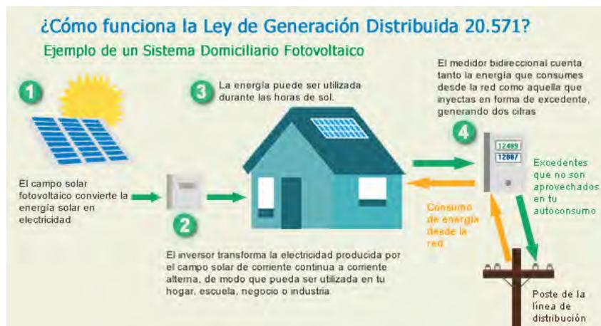
Figura 3. Sistema fotovoltaico dentro de la ley 20.571. Fuente:
