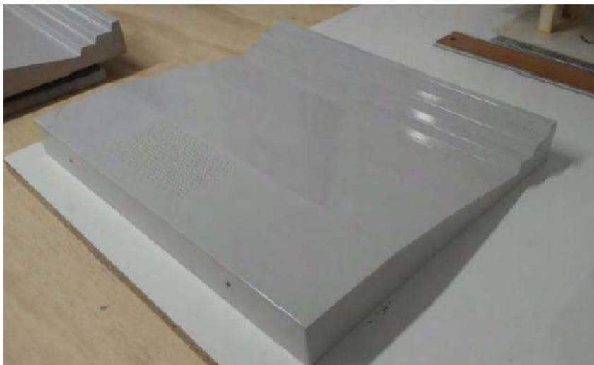
**Figura 87. Piezas en proceso de cobertura con aparejo previo a la pintura final.**
