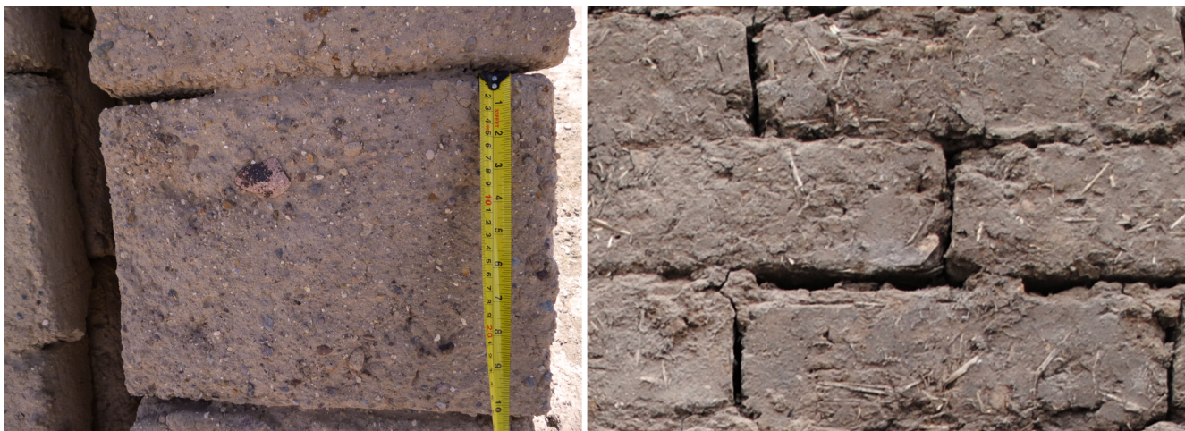
Imagen 3. Comparación entre un adobe andino de 40x30x10cm. con piedrecillas y uno del valle central de 60x30x10cm. con paja (fuente: el autor).
