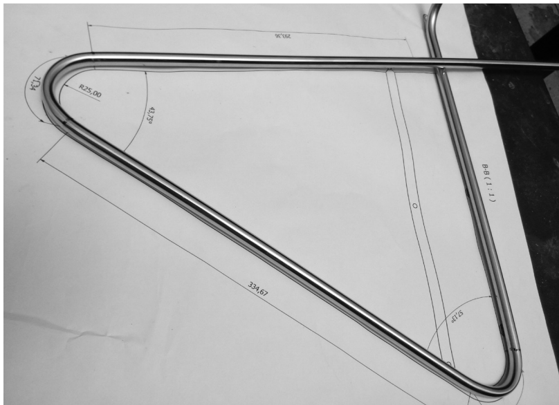
Imagen 89: Proceso curvado tubo Fuente: elaboración propia
