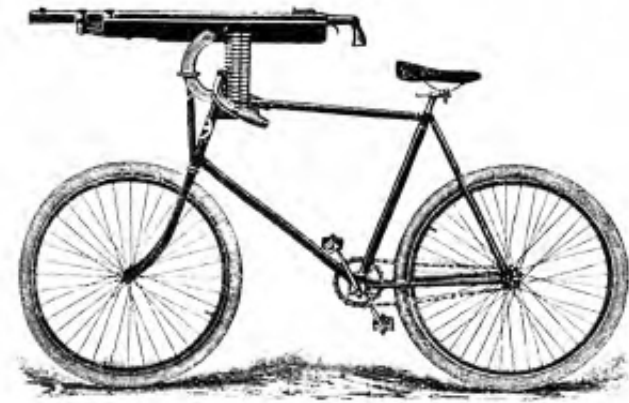
Imagen 2. 1896 Bicicleta militar equipada con una ametralladora Browning Fuente: Bicycle design: An illustrated history
