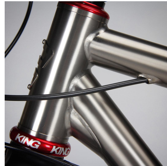
Imagen 10: Cuadro de titanio construido por soldadura TIG Fuente: Firefly Cycles
