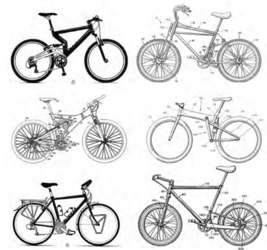
Imagen 5: Arriba Izquierda: Típica mountain bike de doble suspensión de principios de los 2000's (Geoff Apps). Centro izquierda: Trek de 1995, marco con diseño en "Y". Abajo izquierda: Típica bicicleta rígida para trekking/turismo de principios de los 2000's (Geoff Apps). Arriba derecha: Diseño de suspensión completa de Mert Lawwill de 1987. Centro derecha: Klein de 1995 con diseño de triangulo trasero con pivote unificado. Abajo derecha: Mert Lawwill de 1990 con diseño de suspensión trasera en paralelogramo. Fuente: Bicycle design: An illustrated history
