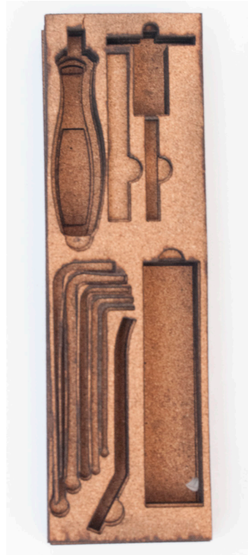
Imagen 109: Desarrollo de los soportes para herramientas, caucho y corcho Fuente: Elaboración propia
