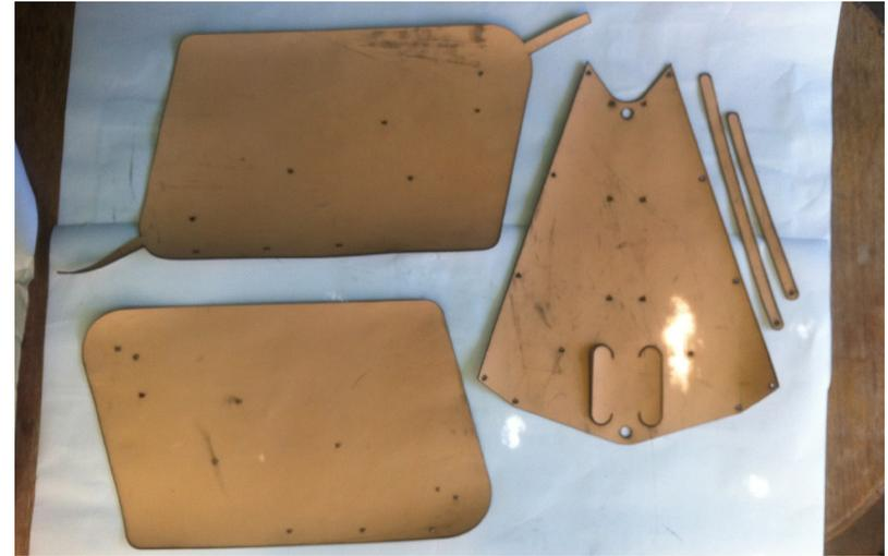
Figura 110. Piezas de cuero cortadas mediante tecnología de corte CNC láser. Elaborado por autor.
