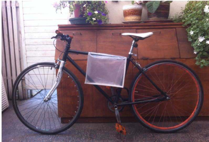
Figura 42. Maqueta de exploración de distribución del volumen, realizada en el polímero Nailon. Elaborado por autor.
