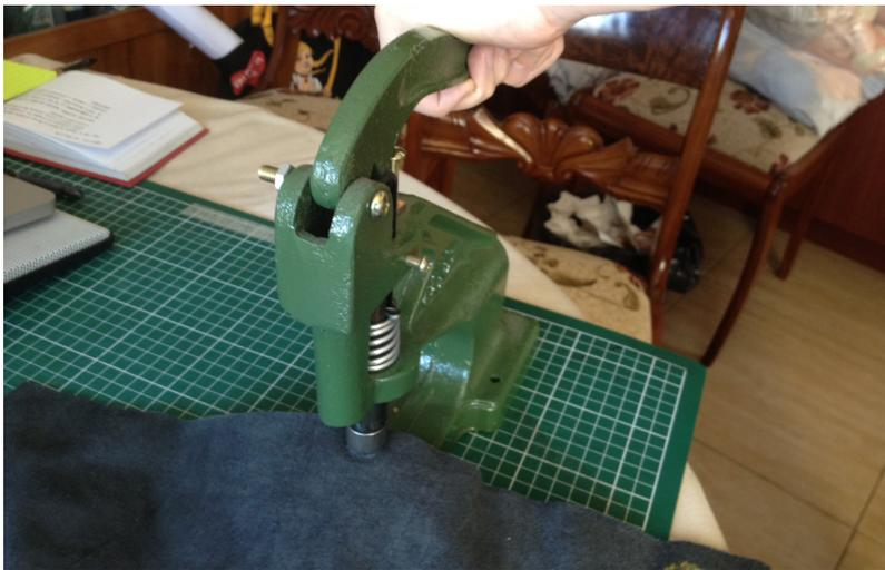
Figura 112. Proceso de aplicación de ojettillo al producto final. Elaborado por autor.
