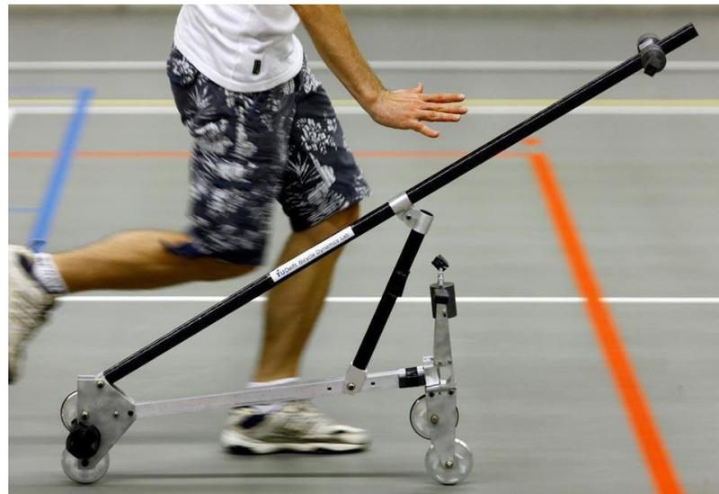
Figura 6. Bicicleta experimental para eliminar el efecto giroscópico de las ruedas giratorias y el “rastreo” de la rueda delantera sigue siendo estable por sí misma. (Ruina, 2011)
