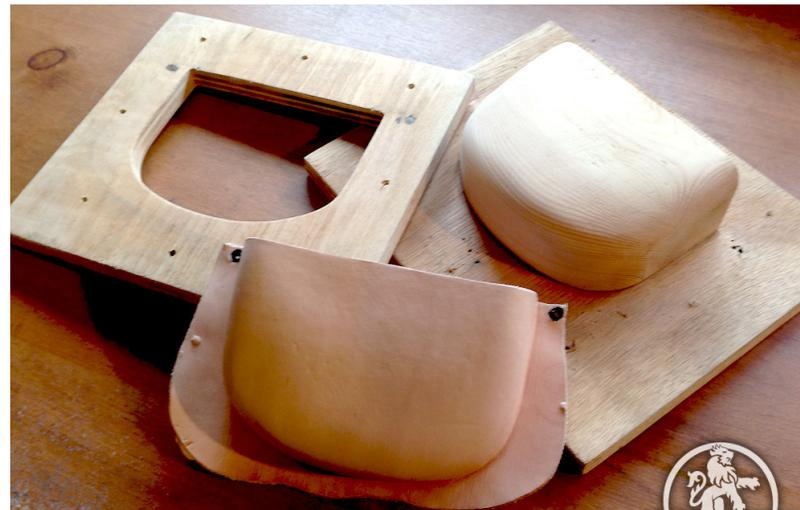
Figura 72. Desmolde de pieza seca moldeada en cuero. (Armd Leather, 2013)
