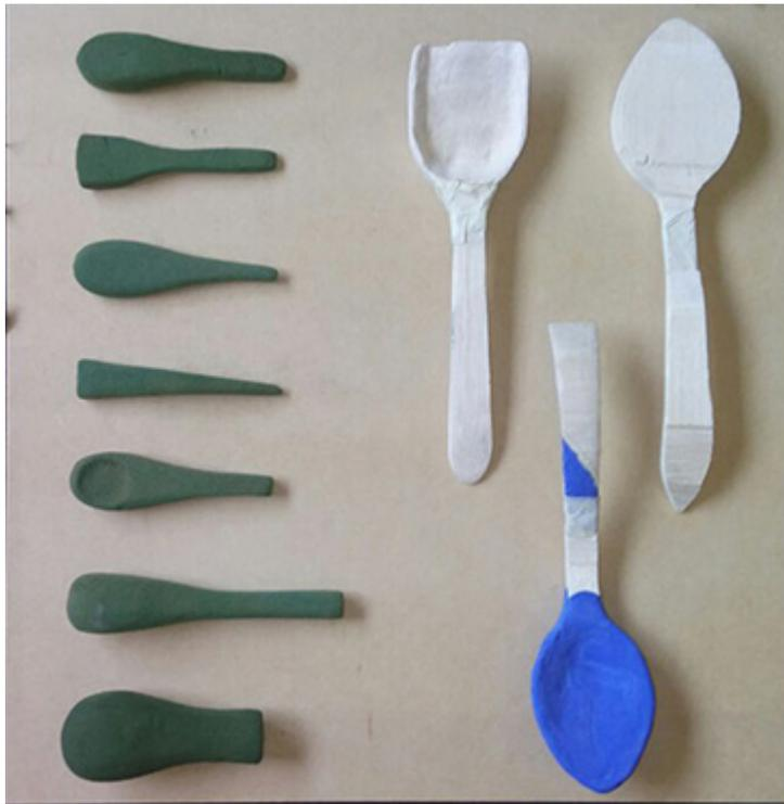
Figura 61. Prototipos de mangos en espuma floral y de cucharas en madera de balsa
