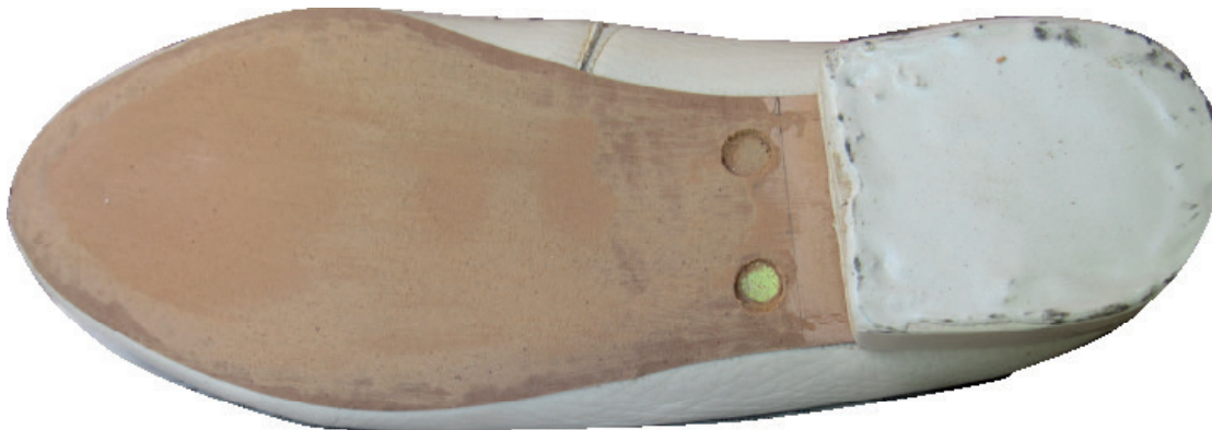
Fig 39 Perforación en suela para imanes de fijación Fuente Elaboración Propia
