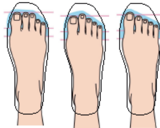
Fig 25 Plantilla nueva punta redonda contrastada con los tres tipos de pie Fuente Elaboración Propia
