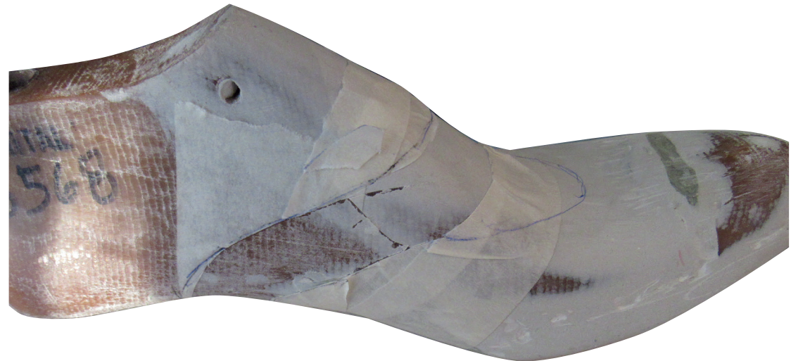
Fig 40 Elaboracion de patrones de corte de accesorios Fuente Elaboración Propia
