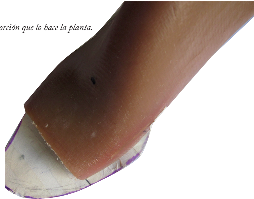
Fig 27 Base de escalado para horma Fuente Elaboración Propia
