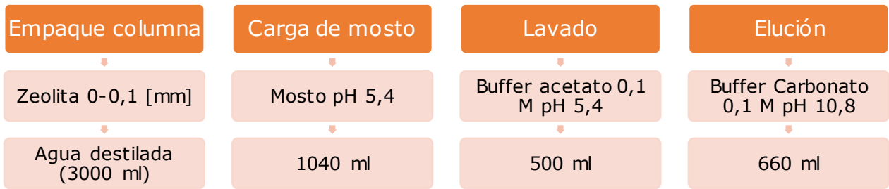
Figura 4-13: Condiciones de operación columna
