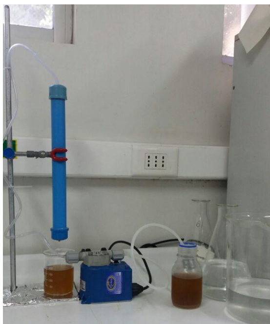
Figura 4-12: Segundo montaje columnas para construir la curva de ruptura del proceso
