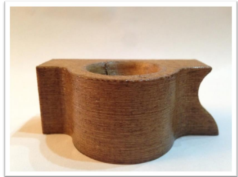
Figura 33. Resultado final de teñido sin lijar de una probeta adicional con corte horizontal (Elaboración Propia)
