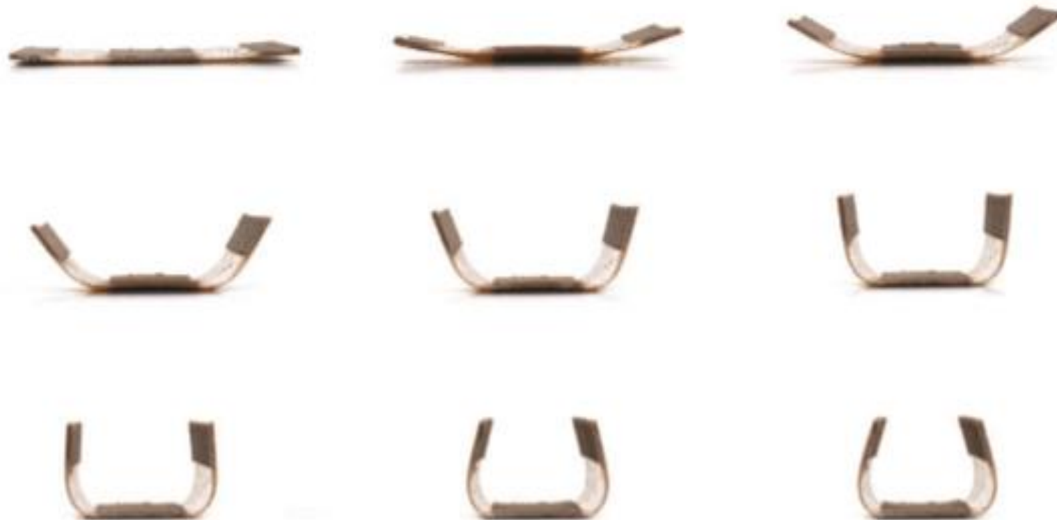
Figura 3. Plegado programado por humedad de una lámina impresa en filamento de madera (Correa, et al., 2015)
