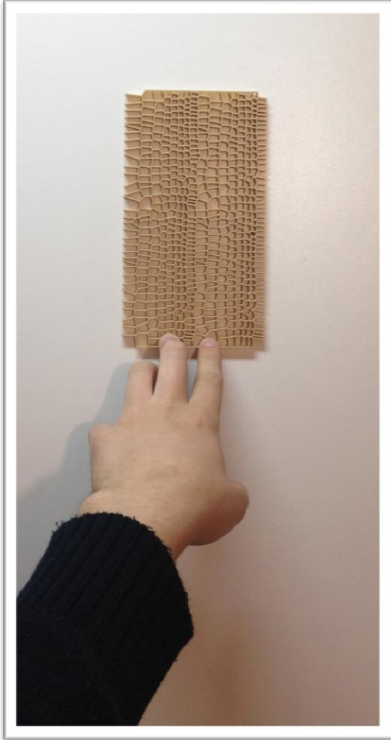
Figura 75. Efecto de veta producido por la réplica del principio de la estructura microscópica de la madera (Elaboración propia)
