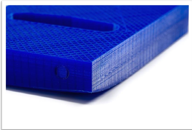
Figura 92. Efecto "warping" o pandeo (Ultimaker, 2017)
