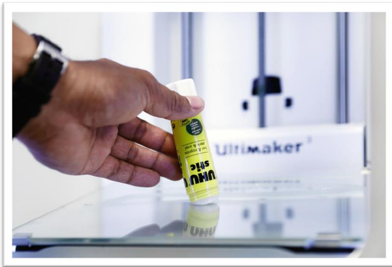
Figura 95. Aplicando una alternativa adicional de adhesión (Ultimaker, 2017)
