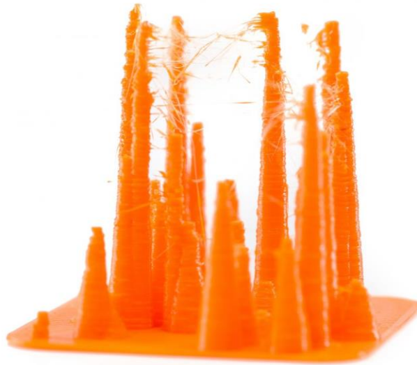
Figura 87. Stringing o problema de restos de hilos (Ultimaker, 2017)
