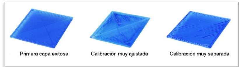
Figura 94. Diferencias en la primera capa según calibración (Ultimaker, 2017)
