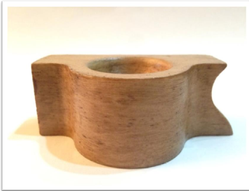
Figura 32 Resultado final de lijado y teñido de una probeta adicional con corte horizontal (Elaboración Propia)
