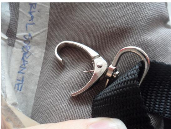
Figura 71: Mosquetón P3 después de las pruebas. Fuente: Elaboración propia.
