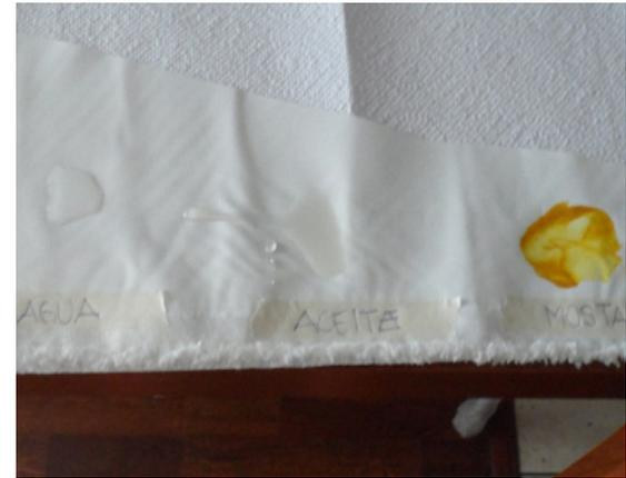
Figura 63: Pruebas de impermeabilidad Oxford. Fuente: Elaboración propia
