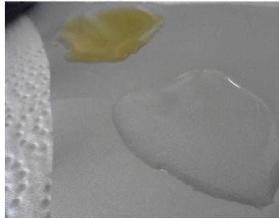
Figura 62: Pruebas de impermeabilidad Taslan. Fuente: Elaboración propia
