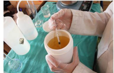
3. Medir la cantidad de peróxido de hidrógeno. Para esta etapa es necesario que el ejecutor cambie de guantes, ya que este elemento concentrado es muy corrosivo para la piel. Mezclar la cantidad medida con el resto de los elementos.
