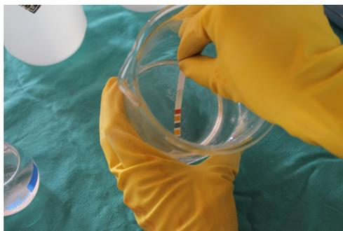
Medir el PH obtenido de la mezcla de agua destilada, peróxido de hidrógeno, imerol y estabilizador, sumergiendo en la mezcla el papel revelador de PH.
