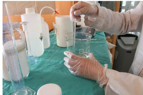
3. Sumergir el sustrato en la solución de descruce, colocar en la cocina y sumergir un termómetro. El proceso debe durar 30 minutos y se debe controlar que la temperatura no sobrepase los 90°C.
