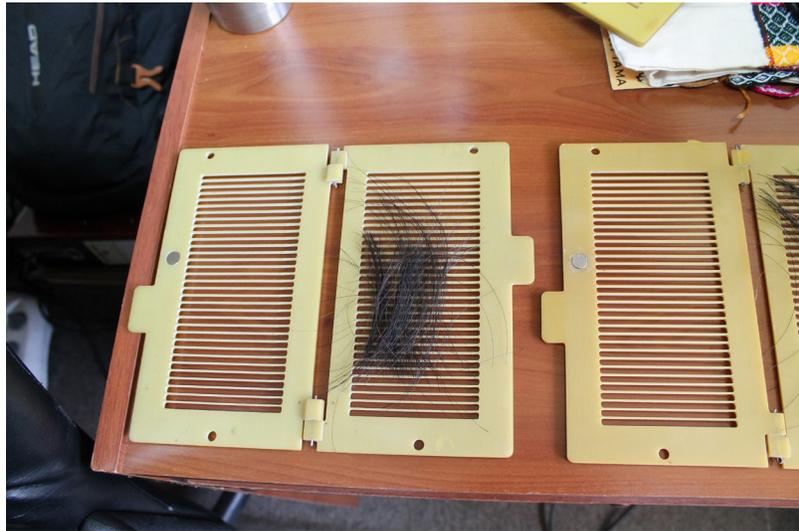
► FIGURA 132: Crin montada pruebas en el instrumento de medición OFDA. Foto de elaboración propia.
