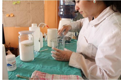
2. Medir la cantidad de imerol necesario, con una jeringa y agregarlo al vaso con agua destilada. Repetir el mismo procedimiento con el estabilizador.
