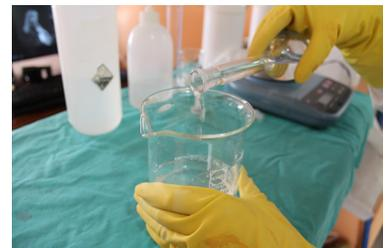
4. Medir el nivel de PH del baño de blanqueo en preparación y luego agregar la solución de sodio tripolifosfato, hasta obtener el PH deseado. Se debe ir testeando el PH, con papel revelador, cada vez que se agregue solución de sodio tripolifosfato.
