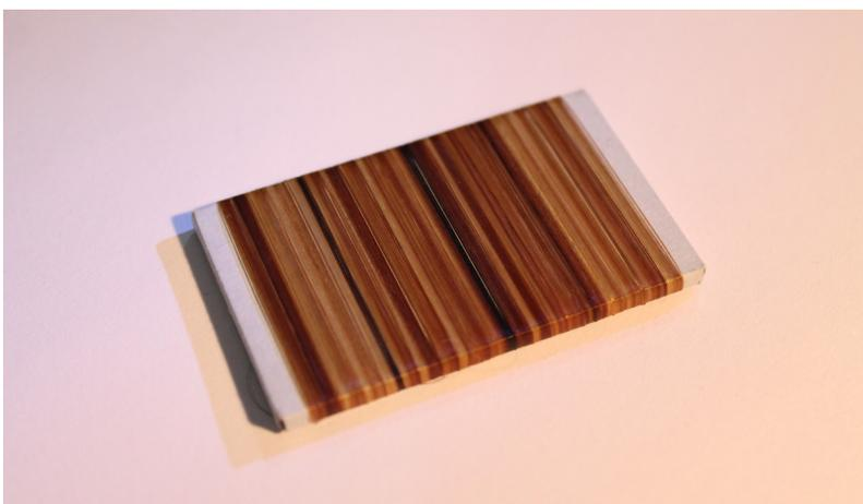
◀ FIGURA 80: Tarjeta elaborada siguiendo el método de presentación de muestras para la medición de color en fibras, 2017, Foto de elaboración propia.
