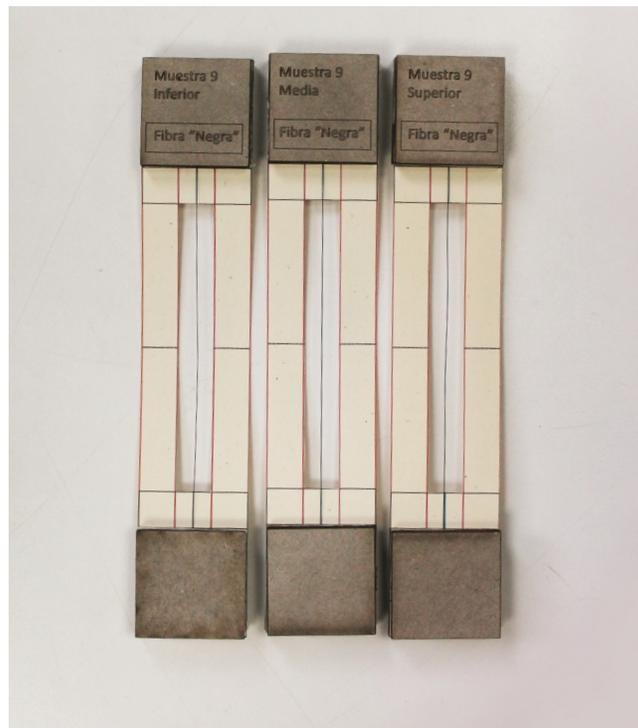
► FIGURA 143: Ejemplos de probetas para ensayos de tracción, Esquema de elaboración propia.
