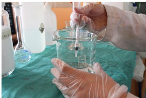
Incorporar al agua cada químico con las cantidades obtenidas en los cálculos, a excepción del sodio tripolifosfato, el que se incorporará después de medir el PH del baño. Esto se debe a que permite obtener el PH exacto que se necesita (Gancén, 1969).
