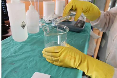
Con el valor de PH definido incorporar gradualmente el sodio tripolifosfato disuelto. Por cada cantidad incorporada medir el valor de PH, modificando dicho valor hasta alcanzar el nivel deseado.
