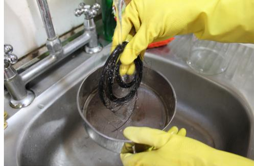
▲ FIGURA 100: Proceso de descruce Esquema y fotografías de elaboración propia.
