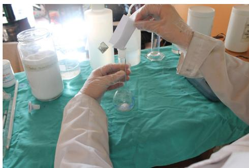
3. Agregar 100 ml de agua y batir hasta obtener una mezcla homogénea.
