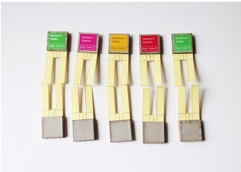
◀ FIGURA 144: Ejemplos de probetas para ensayos de tracción, Esquema de elaboración propia.
