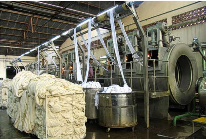
◀ FIGURA 58: Máquina de blanqueo industrial en tela, Por: (inteligente., 2015) Rescatado de: Procesos de ennoblecimiento. Aplicaciones en el área húmeda textil. <http://smartex.com.ar/index.php/procesos/22-pretratamiento-y-blanqueo>
