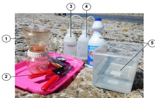
Figura 1: Equipo de filtración manual. Compuesto por: 1.- Embudo de Filtración Nalgene de 250ml. 2.- Bomba de vacío manual. 3.- Piseta con detergente Alcotabs diluido en agua ultrapura. 4.- Piseta Agua ultrapura. 5.- Dilución de Hipoclorito comercial al 10%.
