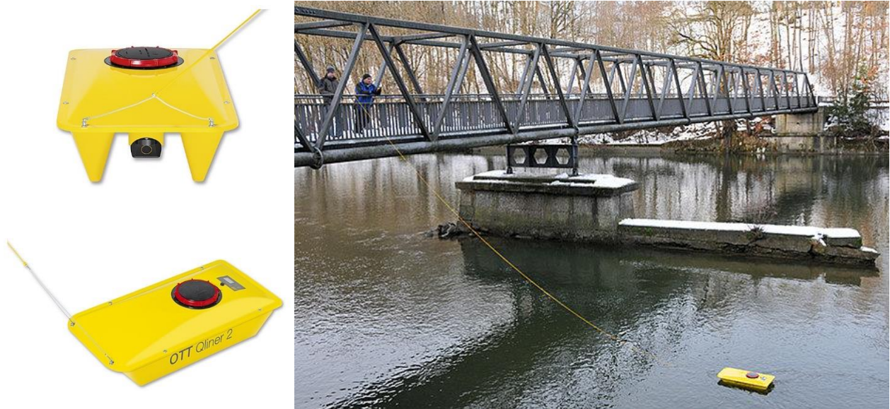
Figura 2.24: Sensor Qliner (izquierda) y aforo de un cauce con el dispositivo (derecha).
