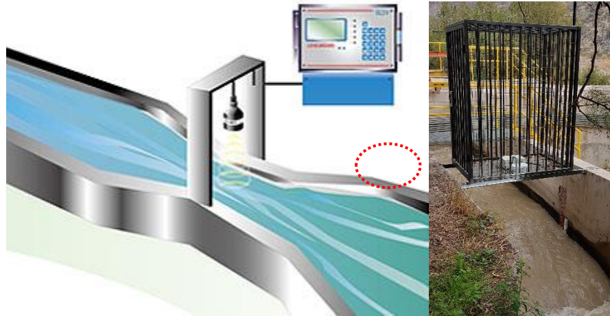
Figura 2.21: Esquema sensor ultrasónico.
