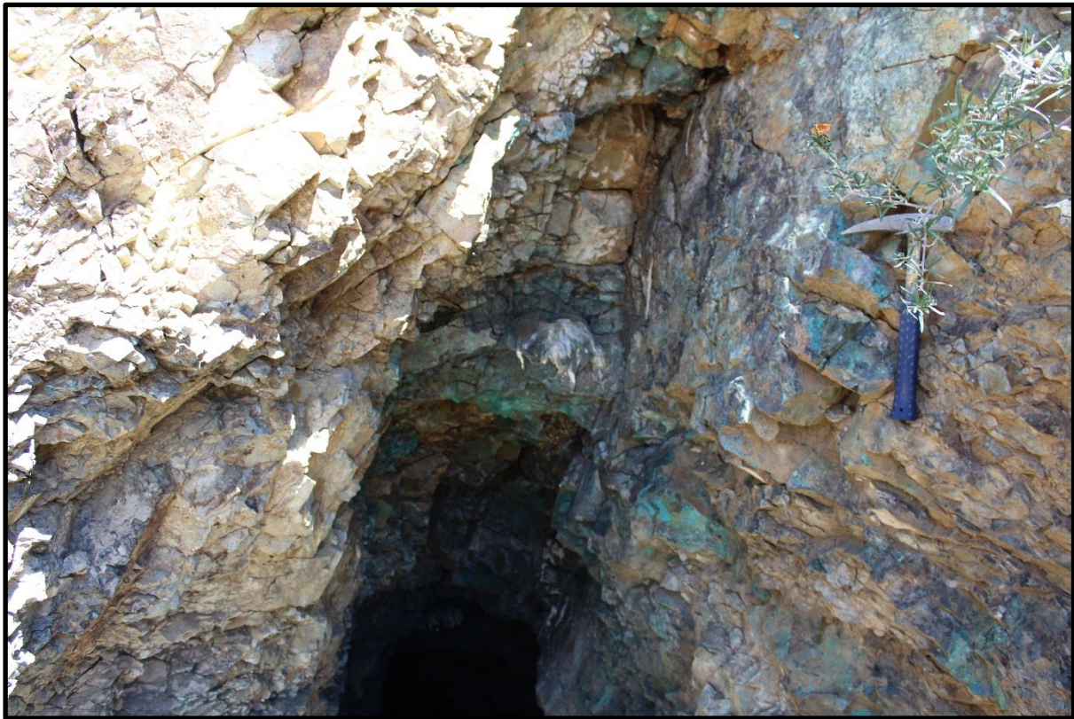
Figura 3.22: Labor de extracción 3 con mineralización de óxidos de cobre, ubicado al sureste de la pertenencia Ignacio Domeyko.
