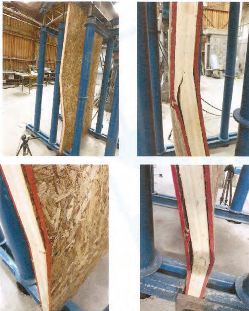
Figura A3-1: Modos de falla observados en paneles.
