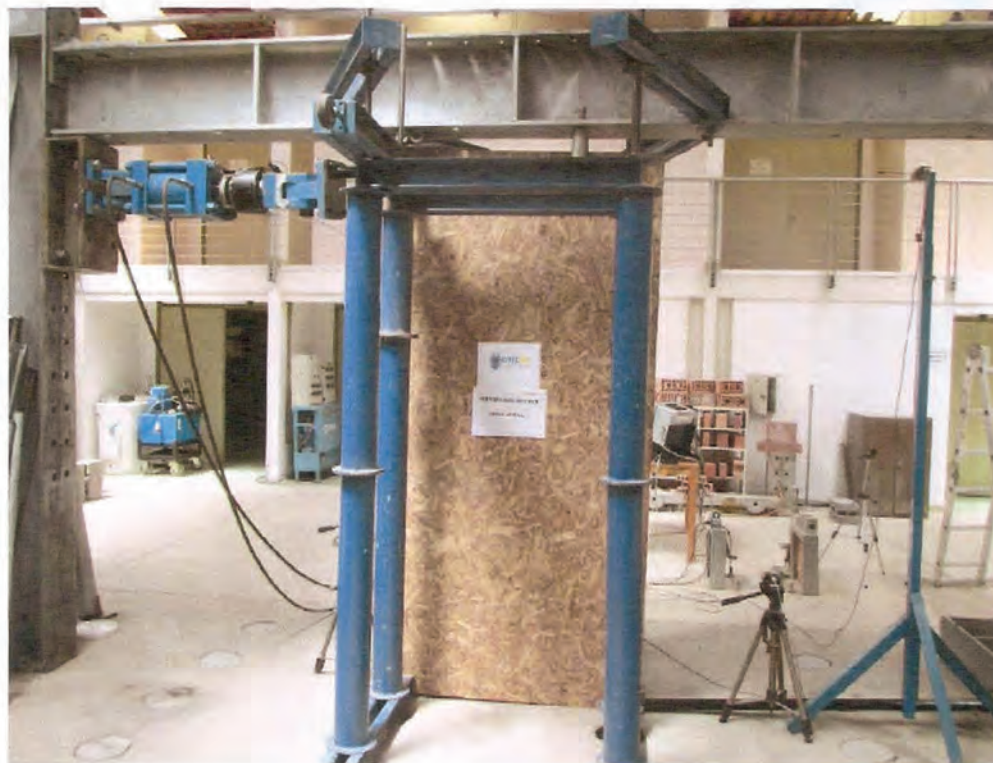
Figura A1: Implementación del ensayo de carga horizontal.
