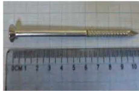
Fotos 2. Espárrago de fijación de soleras a viga de hormigón.
