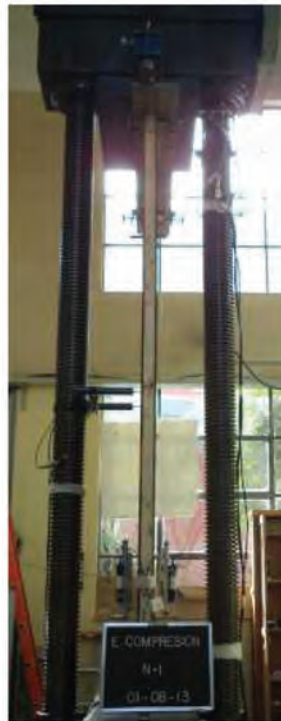
Fotos 3. Vista general del montaje del ensayo de compresión excéntrica al panel.
