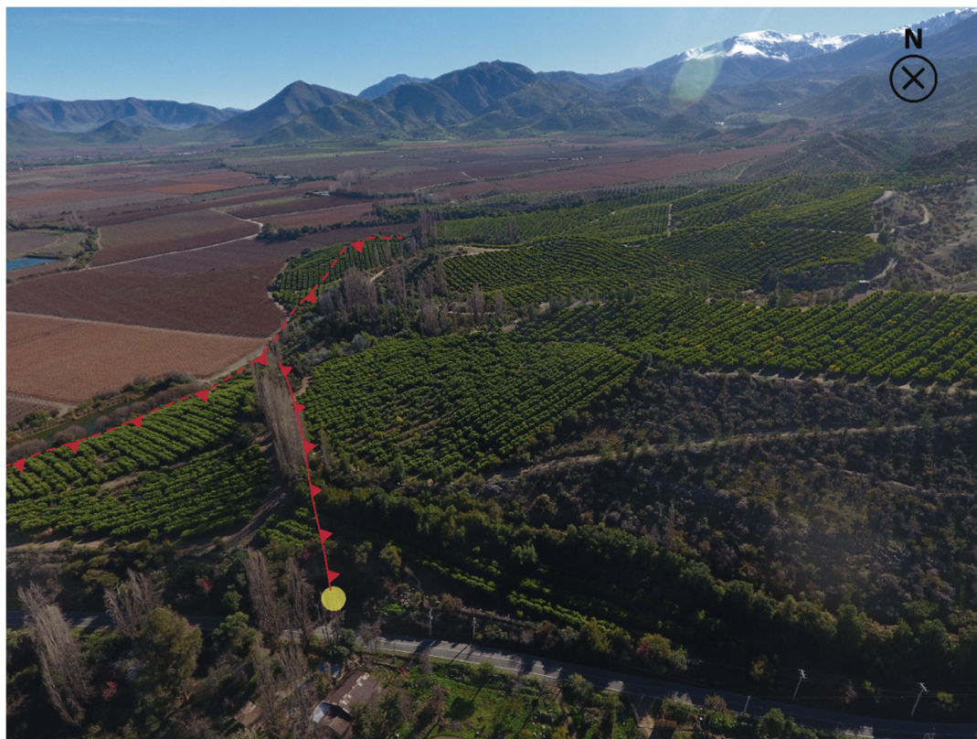
Figura 4.14. Fotografía tomada con el dron que muestra una vista hacia el norte pudiendo observar los escarpes que están señalados con línea roja punteada y con la línea continua la falla observada con un rumbo N50W. El punto amarillo señala el lugar del afloramiento P3.
