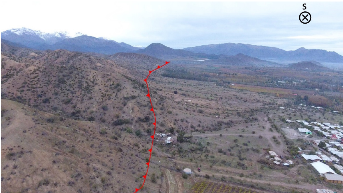
Figura 4.6. Foto tomada con el dron que muestra una vista hacia el sur desde el punto P2. Se puede observar las diferencias de altura y pendiente a ambos lados de la Falla Cariño Botado señalada por la línea roja.
