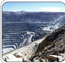
Los taludes en las grandes minas a cielo abierto sufren alteraciones significativas debido a las grandes voladuras de producción y también debido a la relajación de tensiones al retirar el estéril de recubrimiento.
