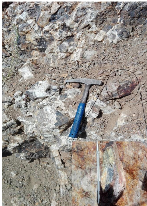
Figura 4.5 Fotografía de set de brechas hidrotermales. En la imagen del borde inferior derecho se muestra el espécimen recolectado del cual se realizó el corte transparente GE-BR4.
