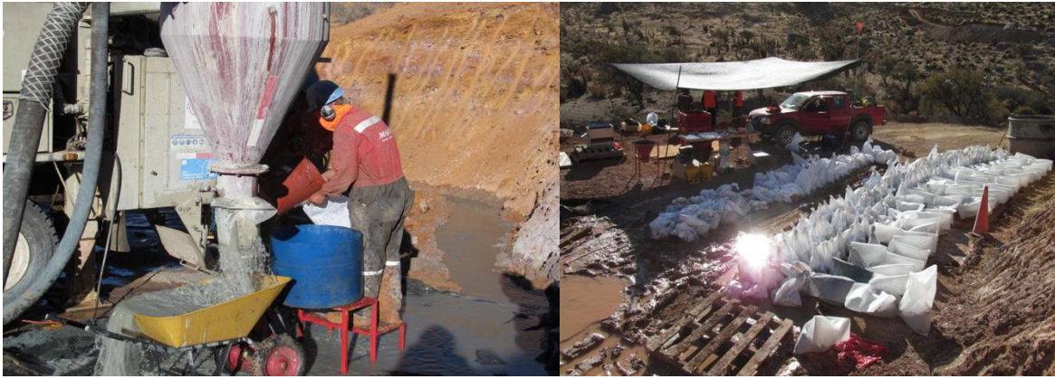
Figura 1.4.3 Trabajos de sondajes de aire reverso a la izquierda. A la derecha se indican las bolsas con muestras.
