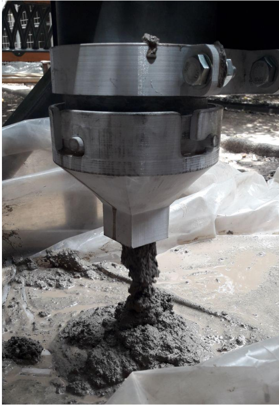
Figura 4-42 Extrusión de hormigón con bajo porcentaje agua/cemento. Fuente: Elaboración propia
