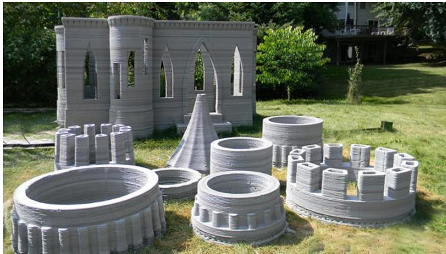
Figura 1-1 Castillo construido con una impresora 3d de concreto. Fuente: (Azzarello, 2014)
