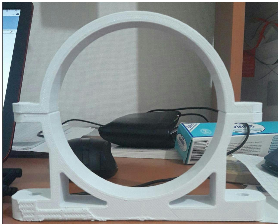
Figura 4-33 Soporte inferior y Cintillo finalizados. Fuente: Elaboración propia
