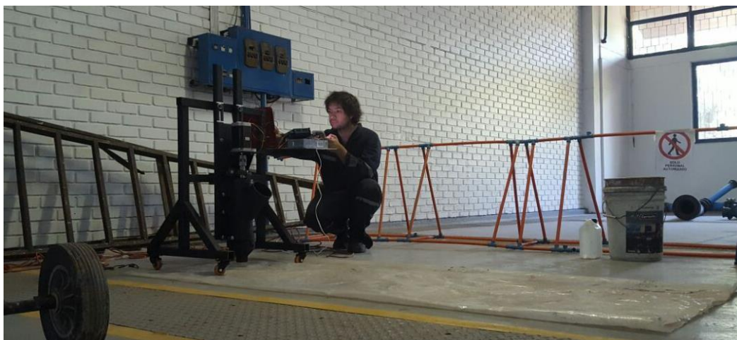
Figura 4-44 Montaje de pruebas de extrusión con desplazamiento. Fuente: Elaboración propia
