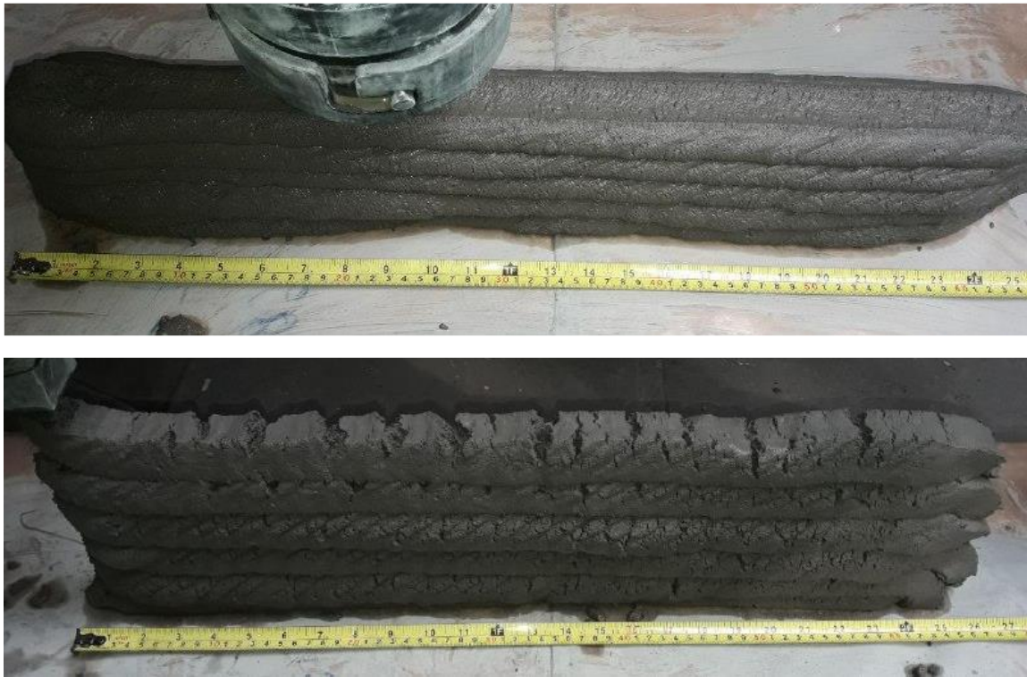
Figura 4-55 Detalle del largo de la pared extruida, de 660 milímetros aproximadamente para ambos experimentos (Arriba: Experimento A, Abajo: Experimento B). Fuente: Elaboración Propia.
