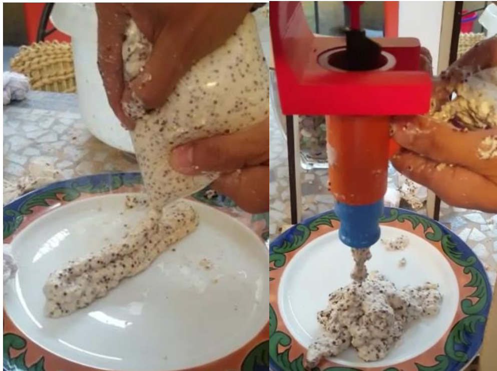
Figura 4-22 a) Simulación del concreto. b) pruebas del compuesto sobre el extrusor. Fuente: Elaboración propia
