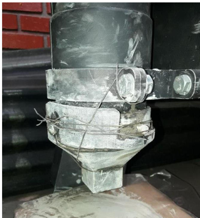
Figura 5-1 Boquilla rota. Fuente: Elaboración propia.
