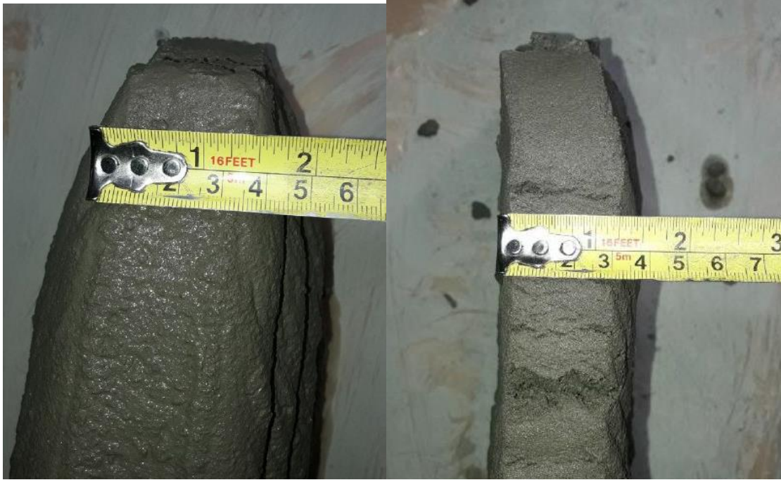
Figura 4-56 Detalle del espesor de la pared para ambos experimentos (Izquierda: Experimento A, Derecha: Experimento B). Fuente: Elaboración Propia.
