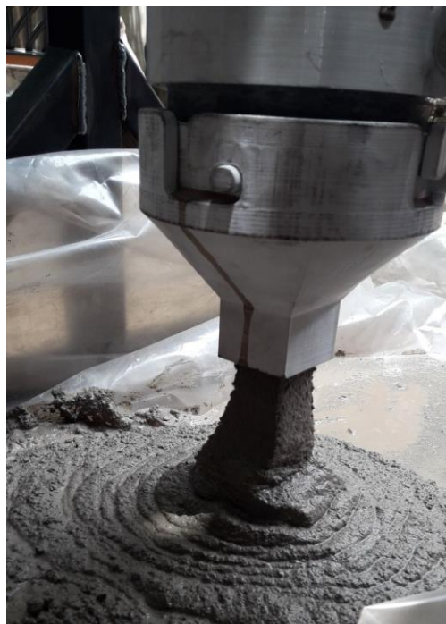
Figura 4-43 Extrusión de hormigón con alto porcentaje agua/cemento. Fuente: Elaboración propia
