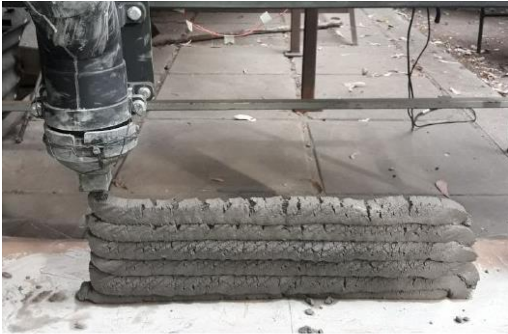
Figura 4-54 Pared resultante del Experimento B. Fuente: Elaboración Propia
