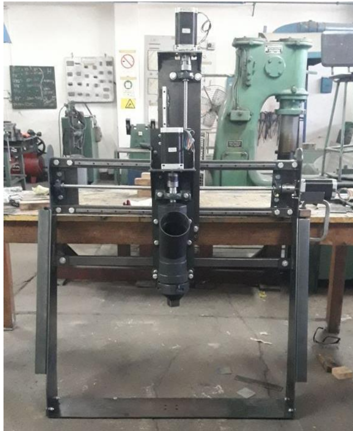
Figura 4-47 Puente, Mesa Horizontal, Porta Extrusor y Extrusor montados, con sus respectivos motores. Fuente: Elaboración propia.
