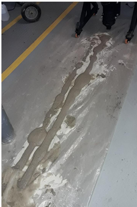
Figura 4-45 Muestra de extrusión con hormigón de bajo porcentaje Agua/Concreto. Fuente: Elaboración propia
