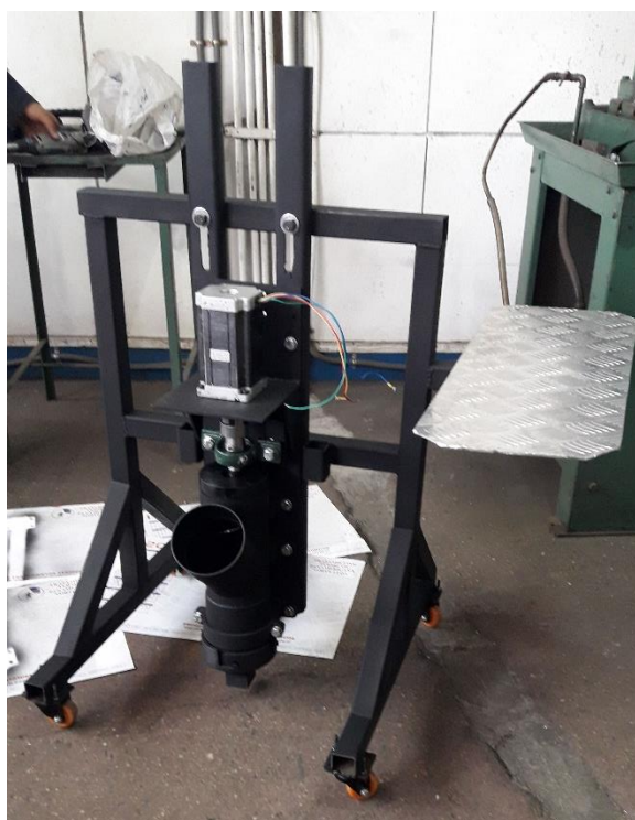
Figura 4-41 Sistema de extrusión y estructura de pruebas finalizado. Fuente: Elaboración propia
