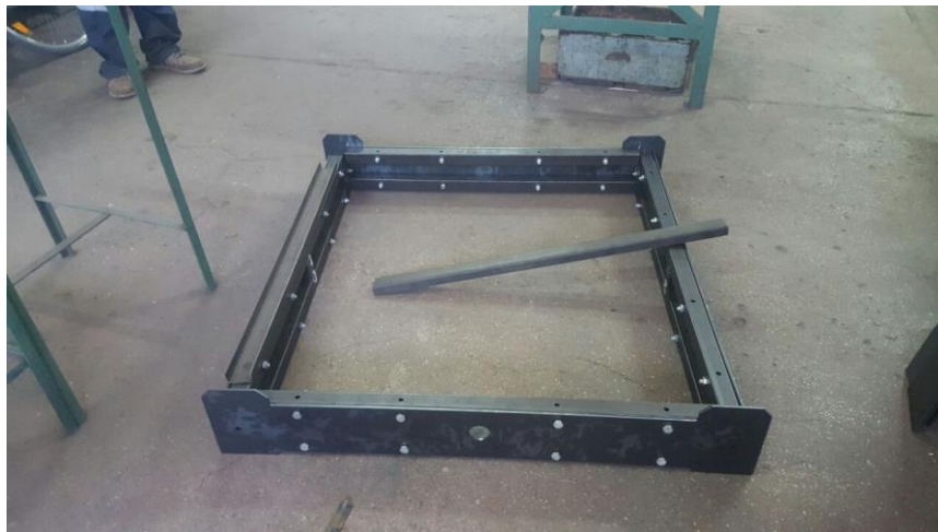
Figura 4-35 Presentación previo al ensamblaje de las piezas del subconjunto Base. Fuente: Elaboración propia
