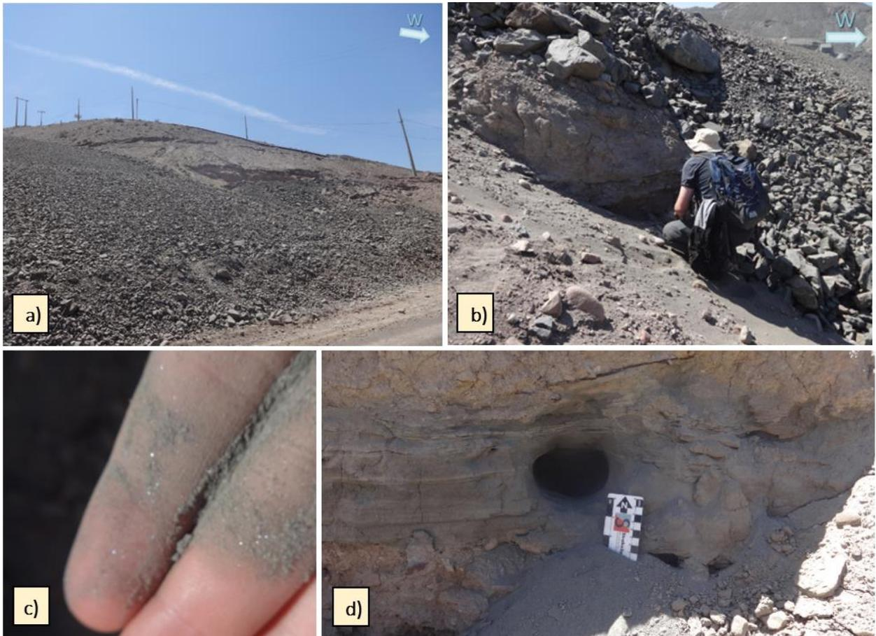
**Figura 8.** a) Cubierta de grava sobre uno de los relaves aledaños a predios agrícolas; b) observación de afloramiento buscando sitio para toma de muestras; c) aspecto del material encontrado en afloramientos: limo-arcilloso y con cristales pequeños de brillo metálico; d) fotografía de un punto de muestreo (muestra R02).
