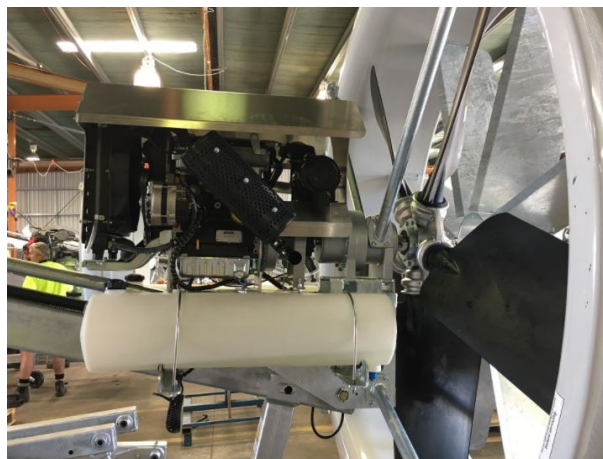
Figura 3.21. Detalle del motor y la estructura que lo sostiene ( Tow and Blow, 2017 ).
