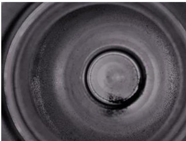
**Figura 9:** Partículas de residuo adheridas a las paredes del envase
