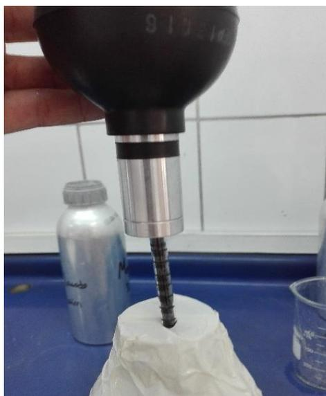
**Figura 2:** Método de medición para cuantificar la Fosfina generada en el primer lavado
