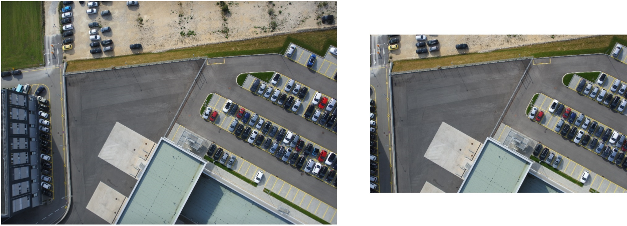
Figura 4.1: Ajuste que recibe una fotografía urbana (imagen de la izquierda) al momento de redimensionarla para que cada uno de sus píxeles cumpla con el criterio de perpendicularidad (imagen de la derecha).
