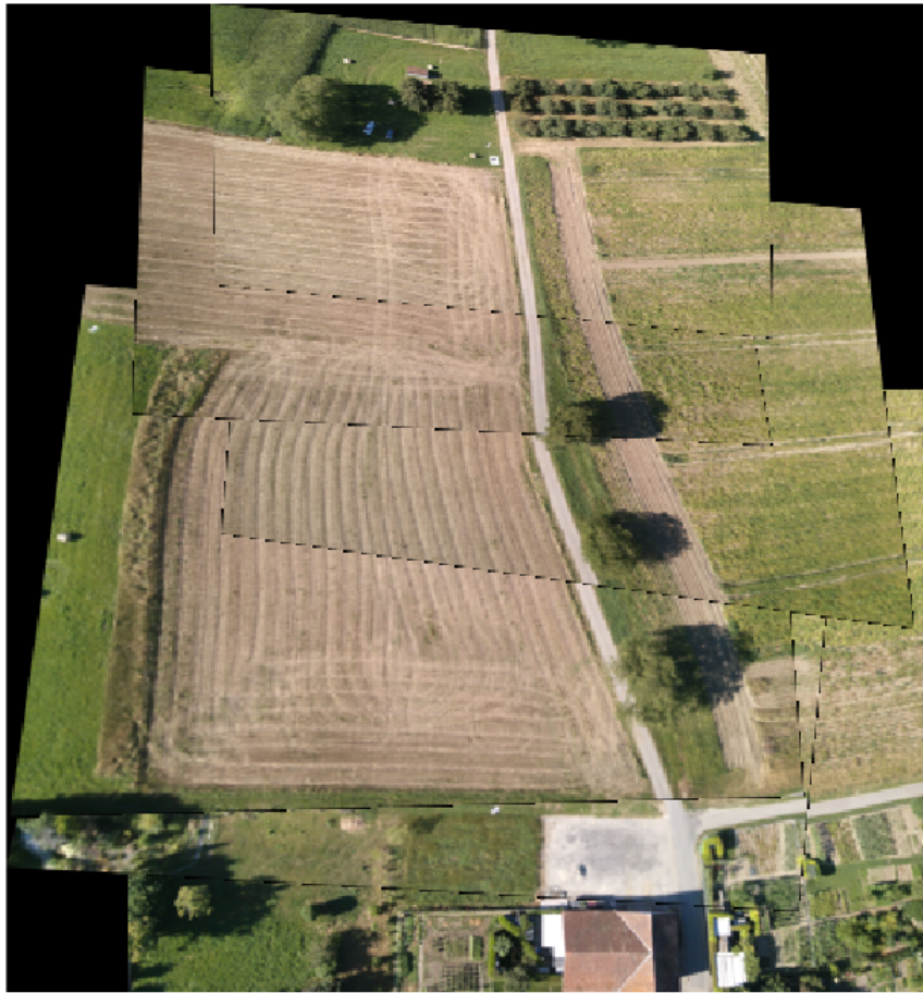
Figura 4.8: Ortomosaico defectuoso debido a la baja calidad y/o cantidad de emparejamientos encontrados en las etapas previas, junto a una falta de mayor procesamiento para llegar al óptimo de la estimación de homografías.
