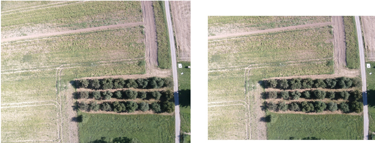
Figura 4.2: Ajuste que recibe una fotografía agrícola (imagen de la izquierda) al momento de redimensionarla para que cada uno de sus píxeles cumpla con el criterio de perpendicularidad (imagen de la derecha).
