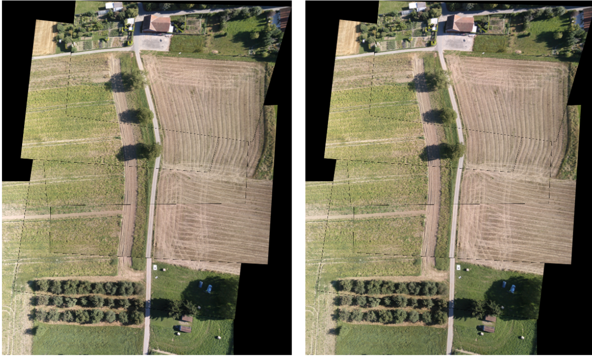
Figura 4.12: Escenario A (izquierda) al que se le aplica un ajuste de intensidades en base a ganancias variables (derecha).
