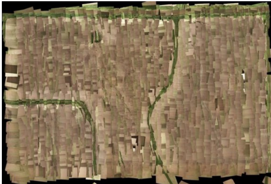
Figura 2.12: Mosaico rugoso formado a partir de imágenes aéreas usando solamente los datos del GPS y de la IMU [10].
