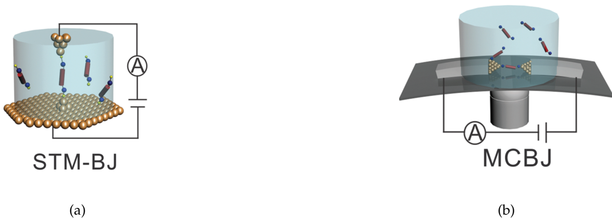
Figura 6.1: Ilustración esquemática de un sistema (A) STM-BJ; y, (B) MCBJ. [73]
