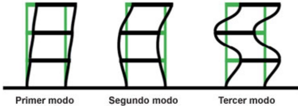
Figura 2.1: Modos de vibración de un modelo de edificio simple.[3]
