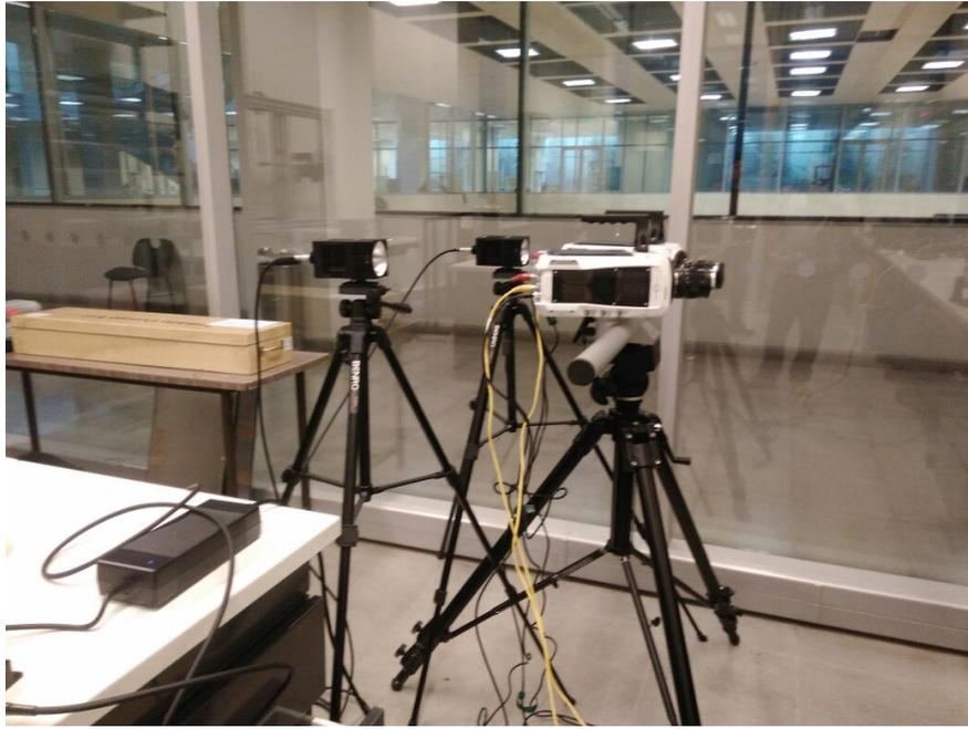
Figura 3.2: Cámaras de alta velocidad Phantom Modelo Q450 y focos led para iluminación constante.
