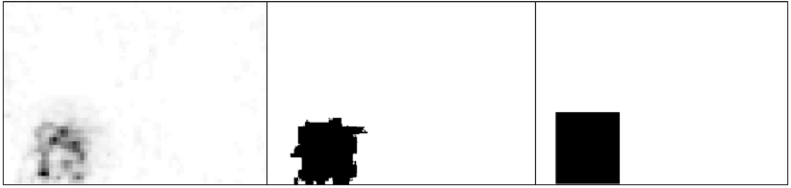
Figura 4.19: a. Mapa de índices de daño, b. Daño detectado en base a Variación de Gradientes, c. Daño original.
