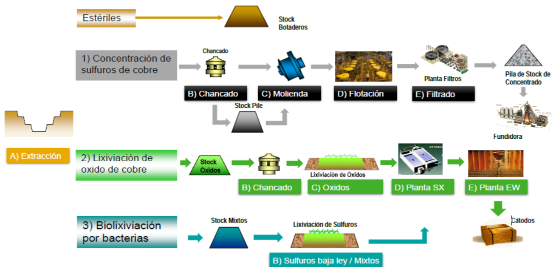
Ilustración 3: Flujograma del proceso productivo del cobre
