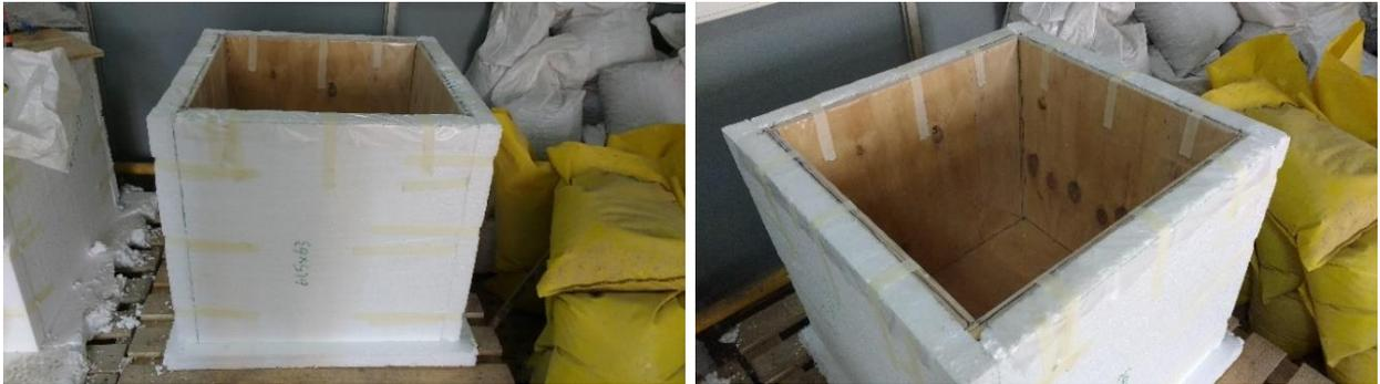
Figura 5.2: molde construido en laboratorio para confeccionar los bloques
