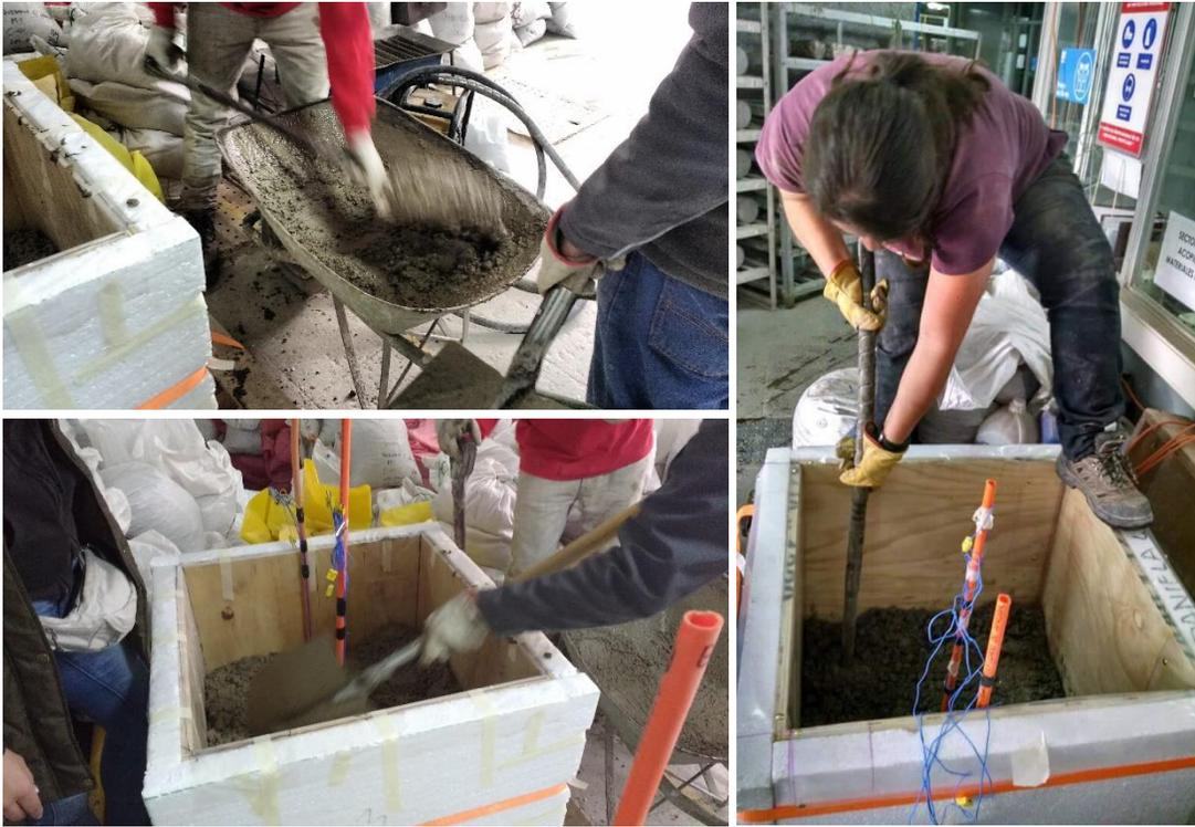
Figura 5.8: registro fotográfico del proceso de confección de uno de los bloques experimentales
