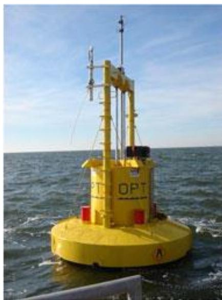
Figura 3.2.12: Generador Power Buoy en operación. [2]
