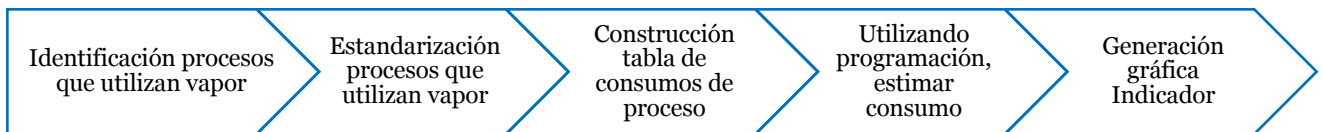
Figura 21: Metodología de construcción de Indicador de Desempeño para el consumo de vapor.
