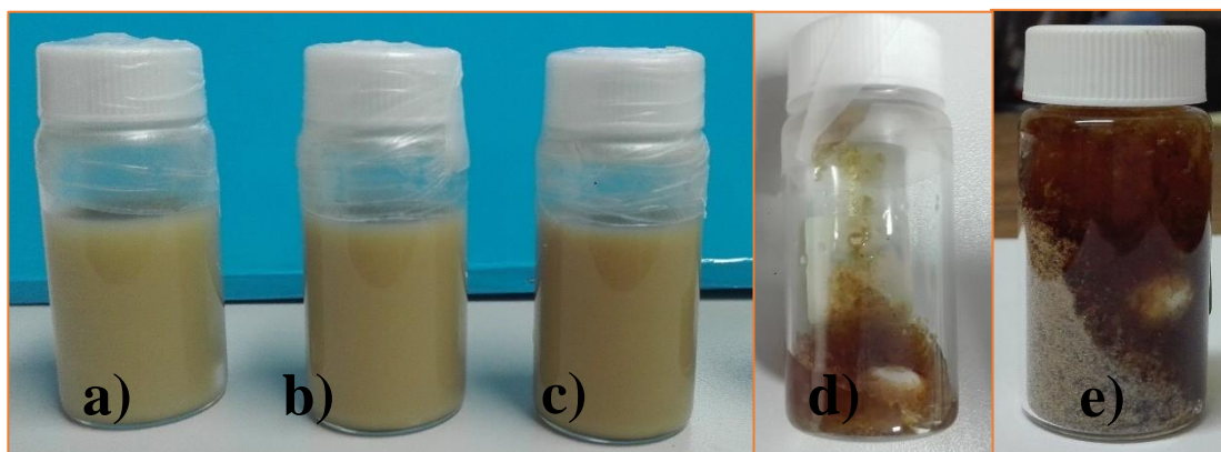
Figura 28. Disoluciones del polielectrolito PEMA-Cys a distintas concentraciones: a) 5% p/v, b) 8% p/v, c) 10% p/v, d) 15% p/v polielectrolito hinchado y e) 20% p/v polielectrolito hinchado.
