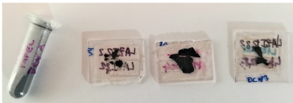
Figura 66. Muestras y porta muestras de vidrio utilizados para realizar las mediciones de XRD.
