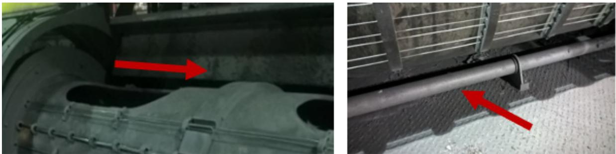
Figura 4.8: Sistema de placas o barras aisladas detectoras de cortes de alambre.
