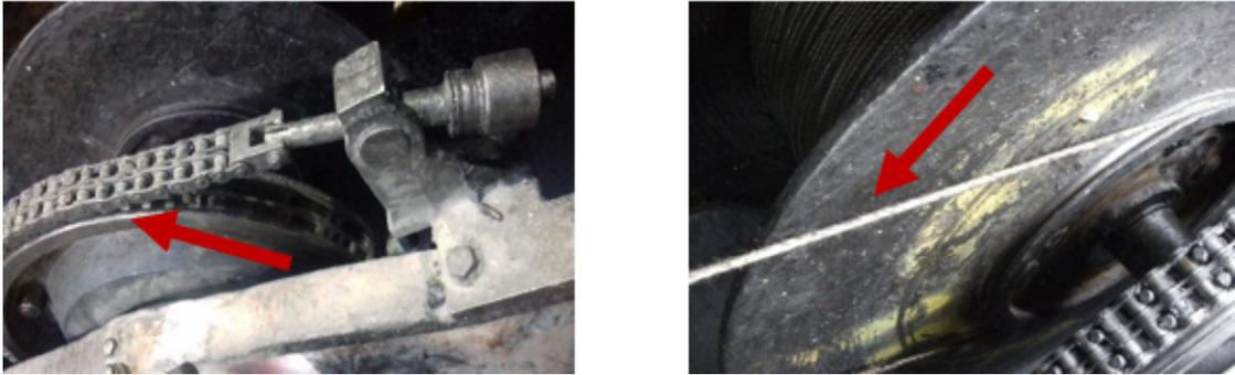
Figura 4.10: A la izquierda se observa un sistema de freno mediante una cadena con insertos, a la derecha se observa un cordel de freno tenso alrededor de una catalina
