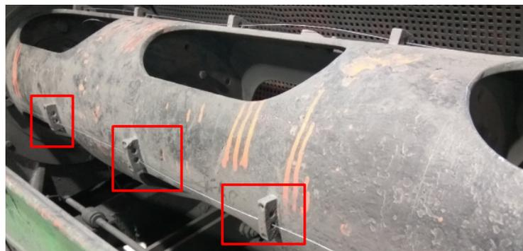
Figura 2.10: Guías de alambre en una máquina tubular.
