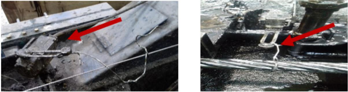
Figura 4.9: Sistema de detección de alambre cortado luego de la formación del torón.
