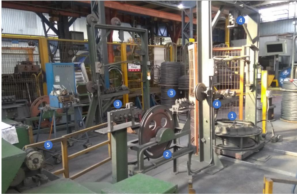
Figura 4.32: Fotografía de la bobinadora B1045A perteneciente a la miniplanta PALA, se muestran los distintos componentes y su disposición
