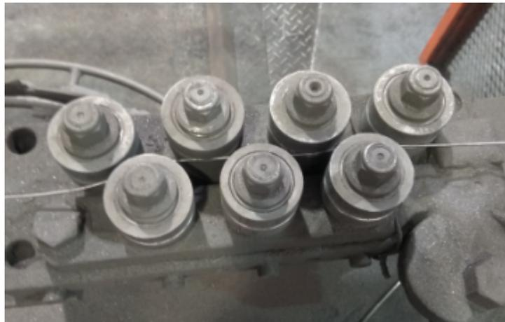
Figura 2.7: Mesa de rodillos para máquina bobinadora.
