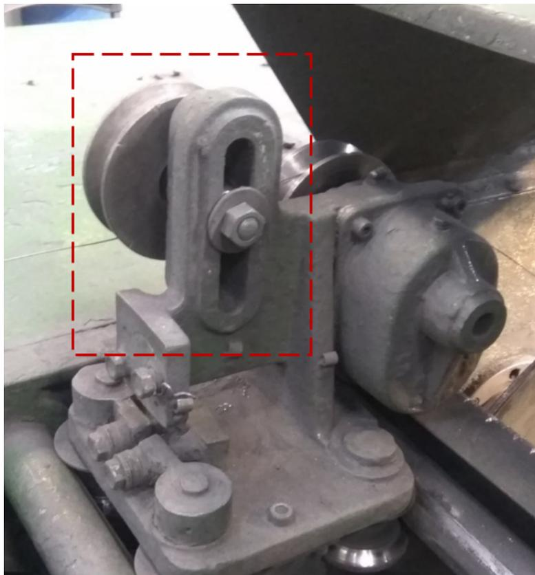
Figura 4.36: Polea a aislar en bobinadora de PALA.
