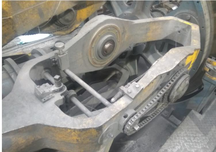
Figura 2.9: Columpio de una máquina torcedora planetaria.
