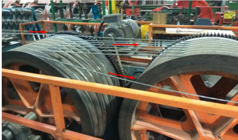
Figura 2.16: Capstan doble con ranuras, las flechas rojas indican la dirección en la cual es jalado el torón.
