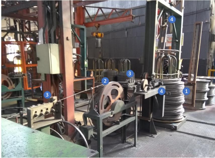
Figura 4.31: Fotografía de la bobinadora B1027C perteneciente a la miniplanta IDB, se muestran los distintos componentes y su disposición
