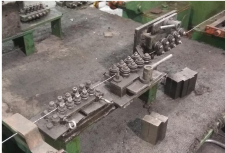
Figura 2.15: Arreglo de postformadores dispuestos en distinta orientación.
