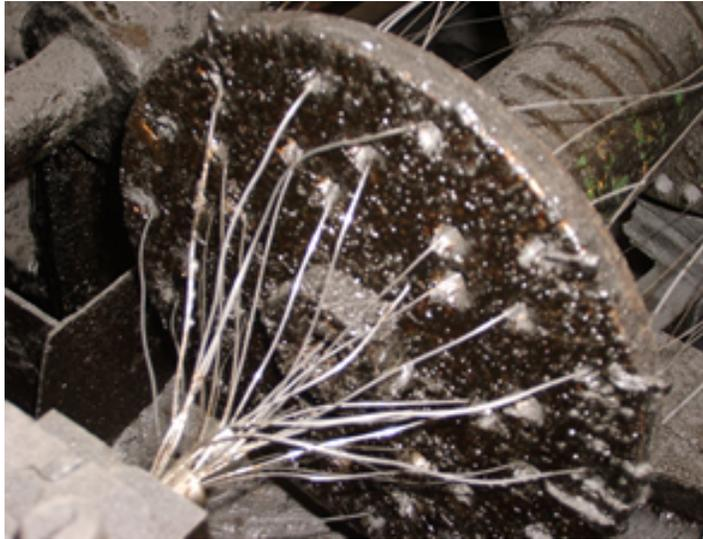
Figura 2.11: Placa divisora para la distribución de alambres.
