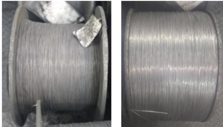
Figura 4.1: Comparación de bobina defectuosa con una correctamente bobinada.
